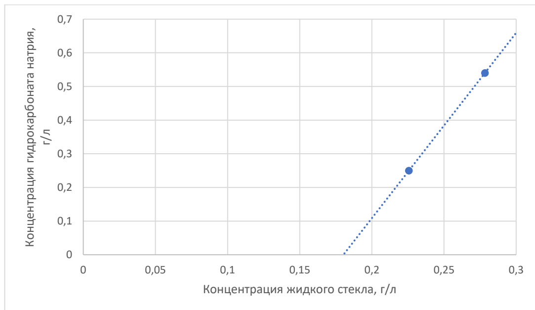
Рисунок 4.12 – Влияние содержания гидрокарбоната натрия на пороговые концентрации силикатов
