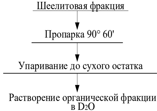
Рисунок 4.6 – Схема проведения модельного процесса пропарки
