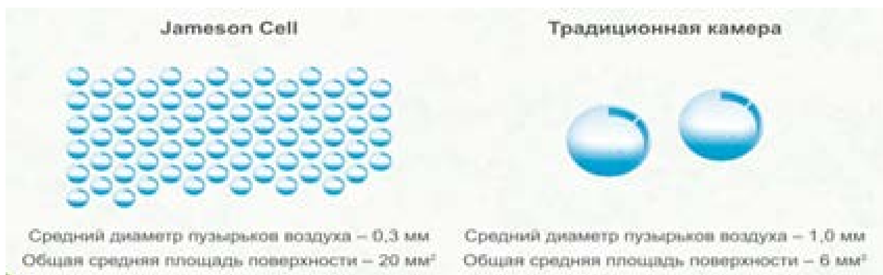
Рисунок 3 Средняя площадь поверхности в традиционных камерах и в «Jameson Cell»
