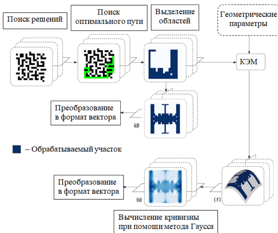
Рисунок 1.31 - Генерация траектории обработки на основе МО [134]
