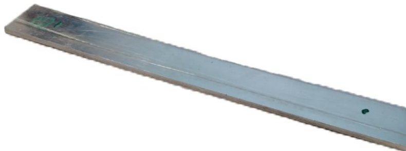
Рисунок 2.1 – Образец для проведения испытаний по определению механических свойств обрабатываемых деталей
