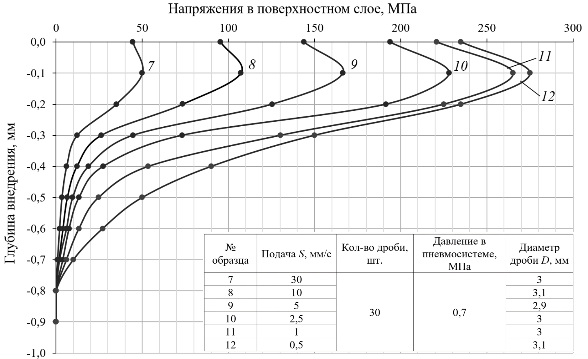
Рисунок В.2 – Эпюры начальных напряжений в образцах, обработанных пневмодинамическим методом
