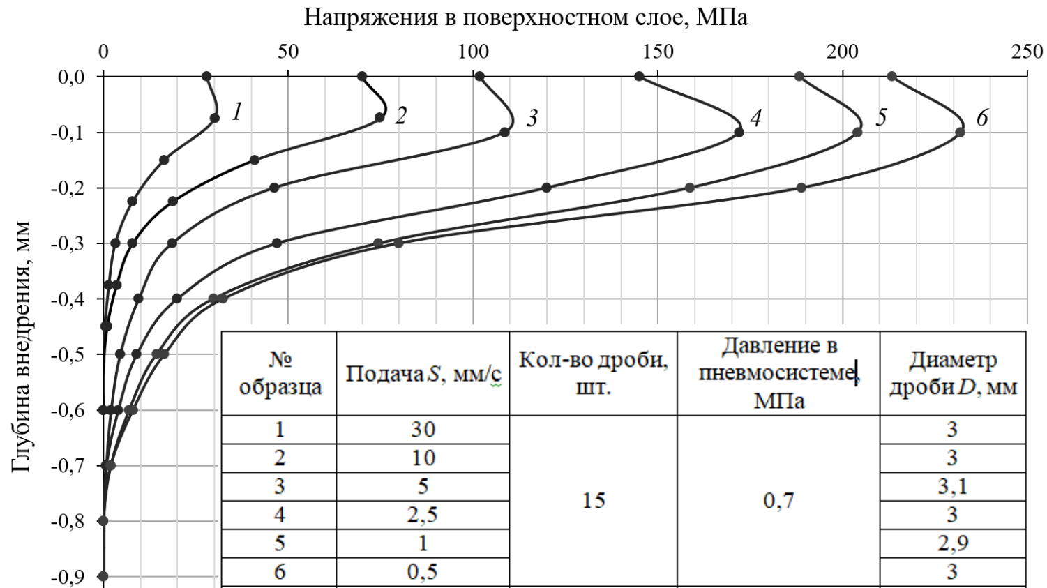
Рисунок В.1 – Эпюры начальных напряжений в образцах, обработанных пневмодинамическим методом
