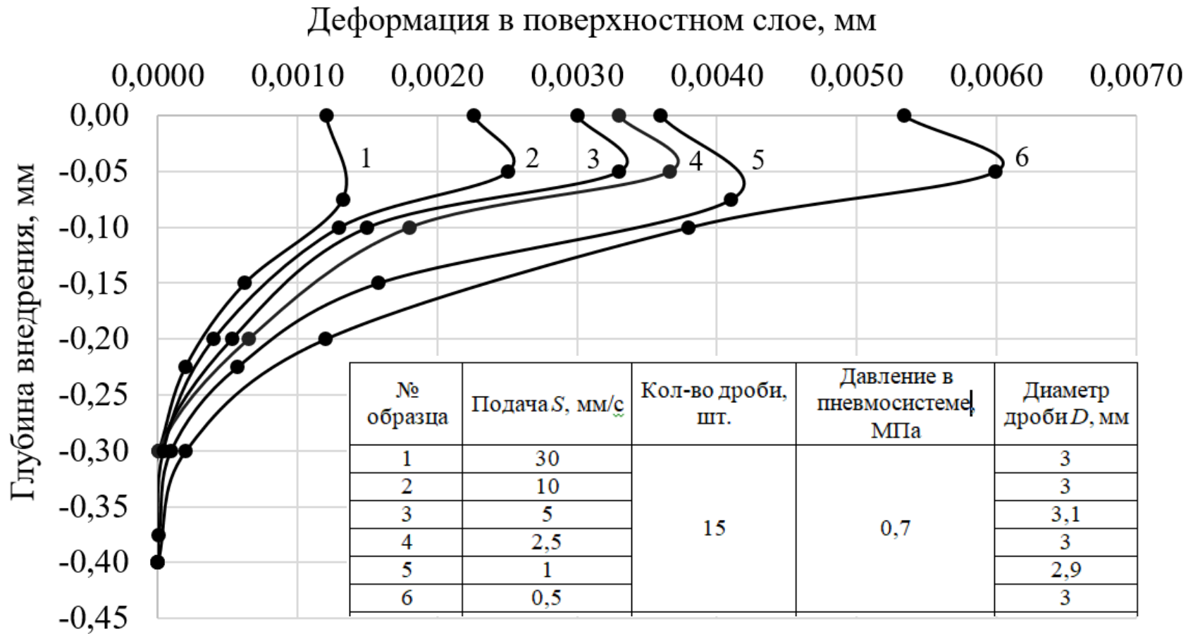
Рисунок В.3 – Эпюры деформаций в образцах, обработанных пневмодинамическим методом
