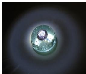
Рис. 11. Бездефектная инклюзия фианита в застывшей стекольной массе
