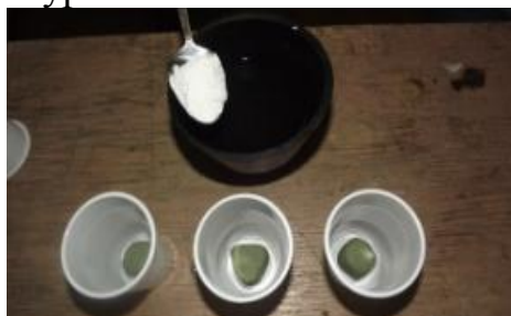
Рис. 8. Заливка форм из замазки гипсом.
