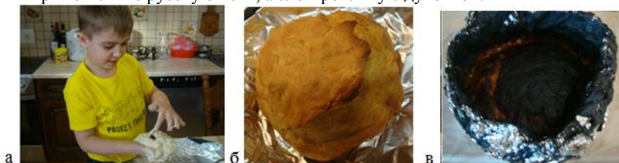
Рис.2. Эксперимент №1: а – закладывание кварца в тесто; б - запекание при температуре 200 0 С, 1 час; в - запекание при температуре 270 0 С, 2 часа.
