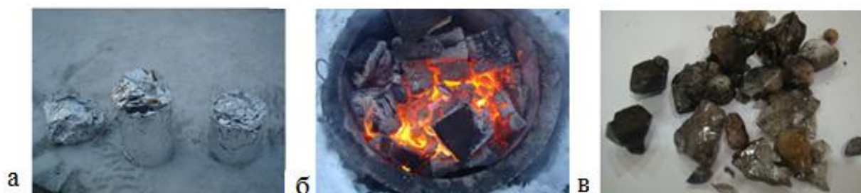
Рис. 3. Эксперимент №2: а - консервные банки с тестом, обмотанные фольгой; б – запекание в костре сосновых дров при температуре 624 °С, 2 часа; в – обожжённые образцы
