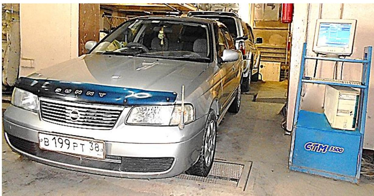
Рис. 4.12 Автомобиль Nissan Sunny FB15 установленный на стенд СТМ-3500 фирмы «МЕТА»
