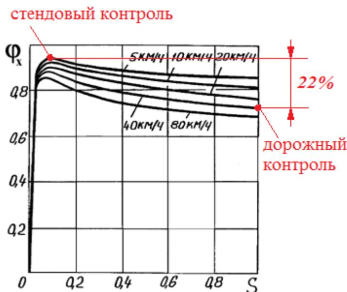
Рис. 1.7 Графики зависимости коэффициента сцепления от величины проскальзывания
