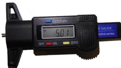
Рис. 3.34 Измеритель глубины рисунка протектора фирмы GemRed модели QST -601
