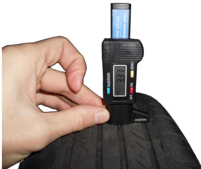
Рис. 3.35 Измерение остаточной высоты рисунка протектора беговой дорожки шины
