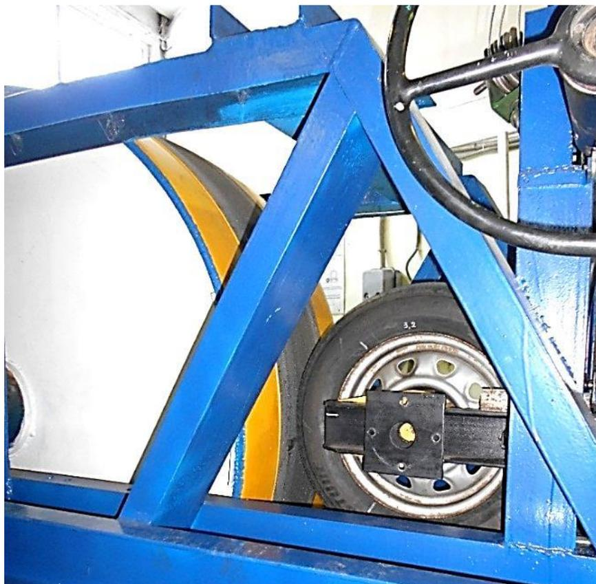
Рис. 3.33 – Колесо, установленное на шинном тестере
