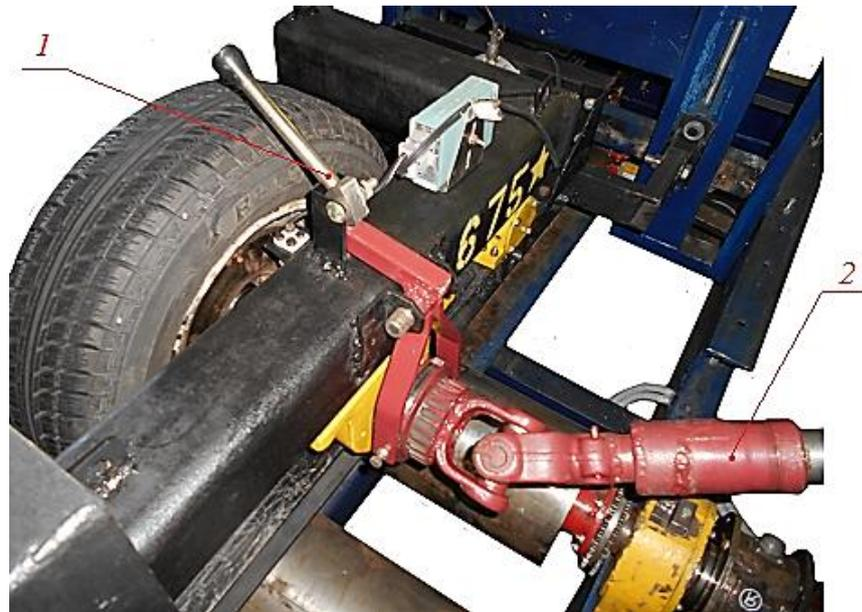
Рис. 3.11. Привод колеса и механизм задания режима его качения: 1 – рычаг переключения режимов качения; 2 – карданный вал.
