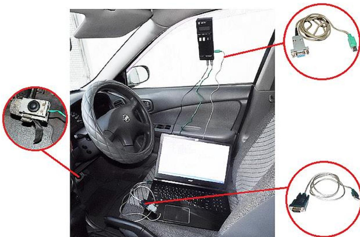
Рис. 3.32 – Прибор «Эффект-02» установленный на автомобиль
