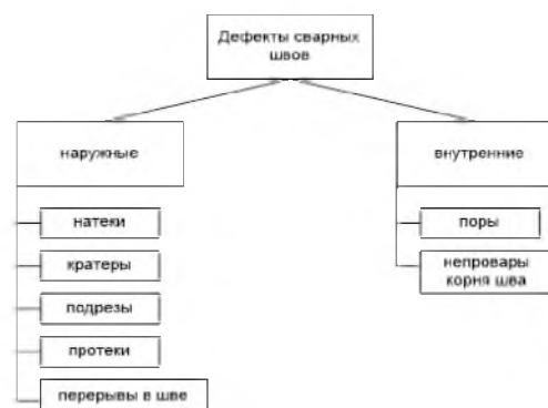
Рис. 3. Классификация дефектов сварных соединений
