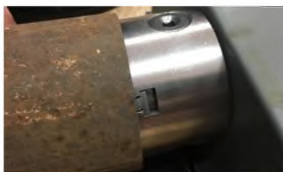
Рис. 4. Расположение трехкулачкового блока в тормозном барабане
