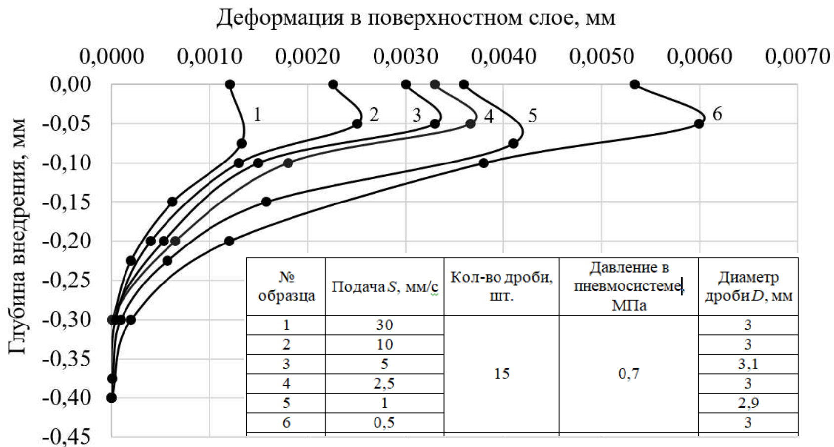
Рисунок В.3 – Эпюры деформаций в образцах, обработанных пневмодинамическим методом
