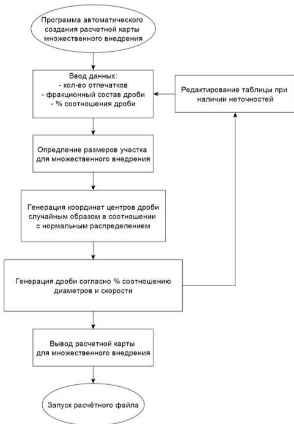
Рисунок 2.13 – Блок схема работы ПО для автоматического создания расчетного файла множественного внедрения
