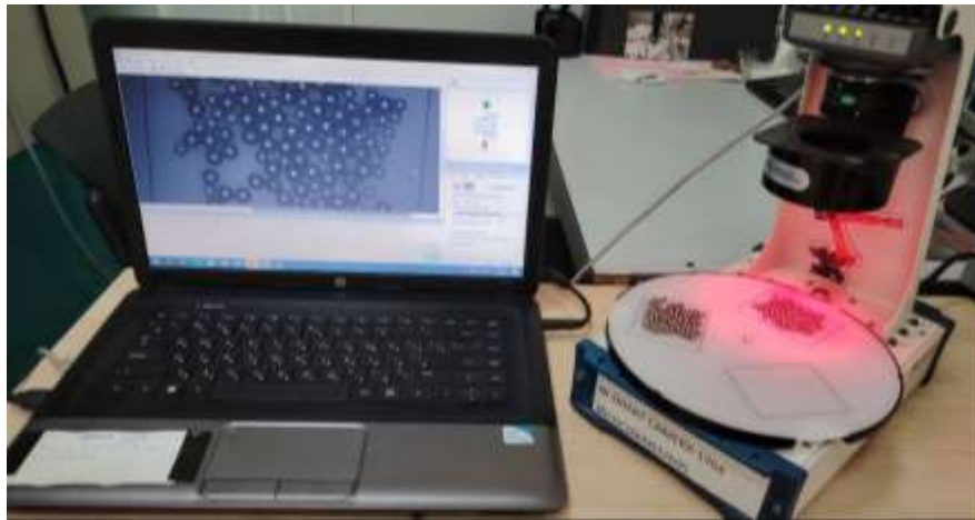
Рисунок 2.4 – Общий вид камеры с техническим зрением National Instrument I Smart Camera 1764 и результат фотографирования изображений
