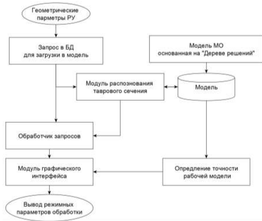
Рисунок 4.21 – Обучение модели для определения режимов обработки
