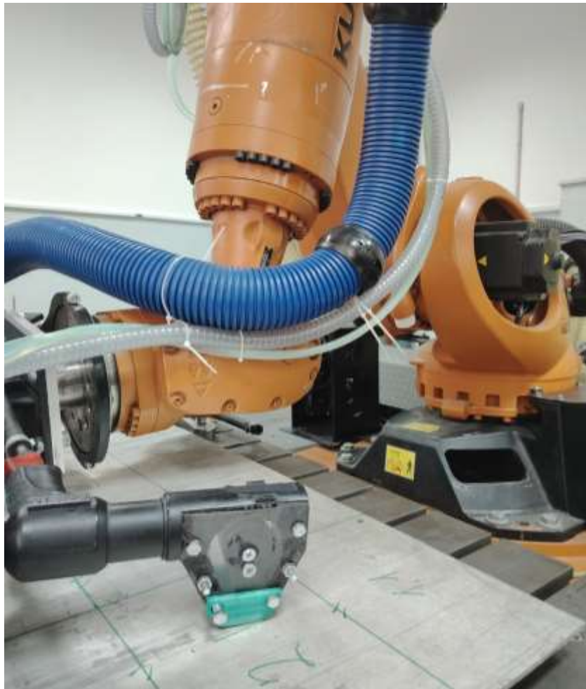
Рисунок 3.16 – ДУФ КПО с использованием инструмента для пневмодинамической обработки дробью
