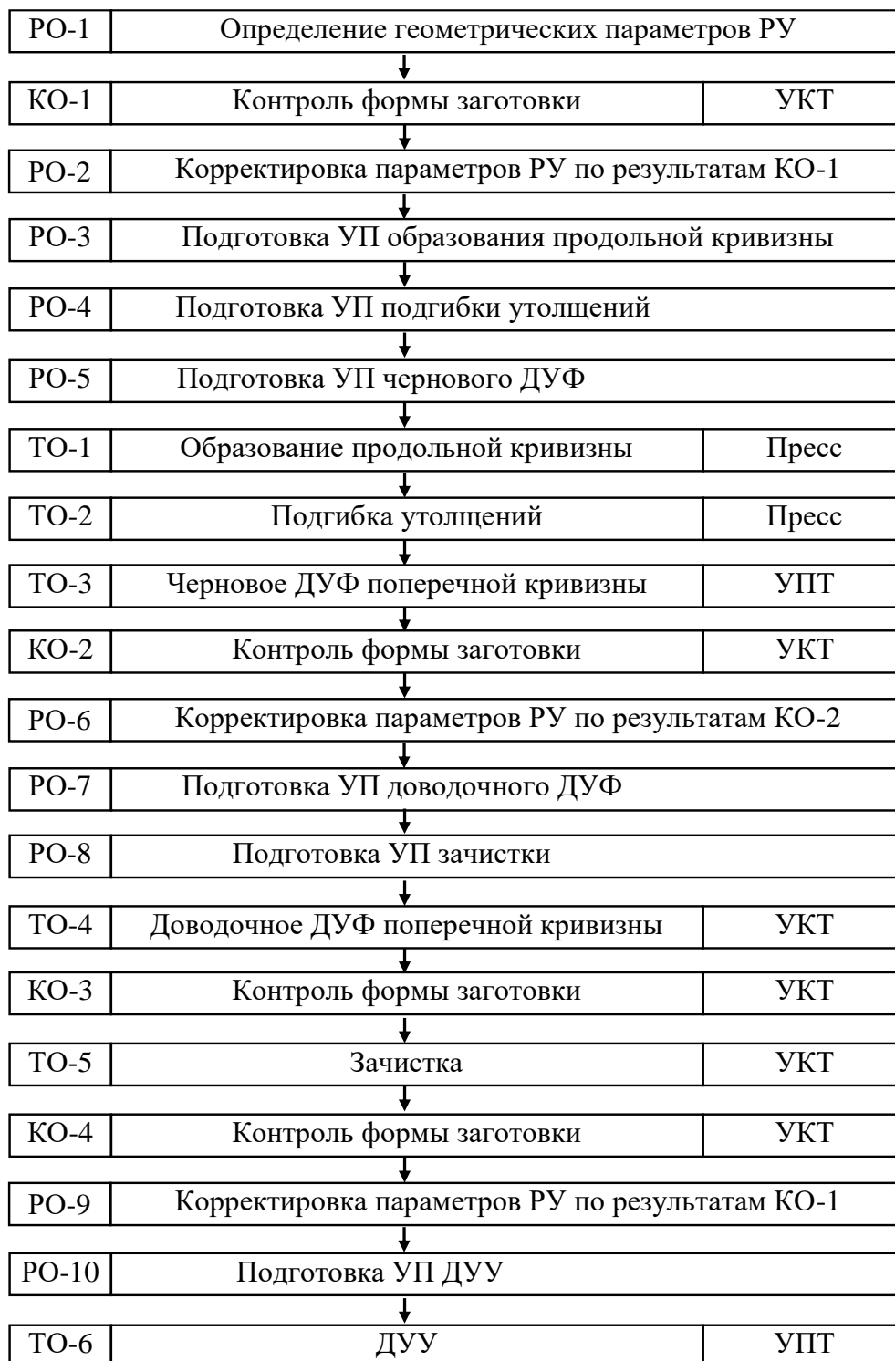
Рисунок 4.4 – Состав операций технологического процесса формообразования-упрочнения деталей типа обшивок
