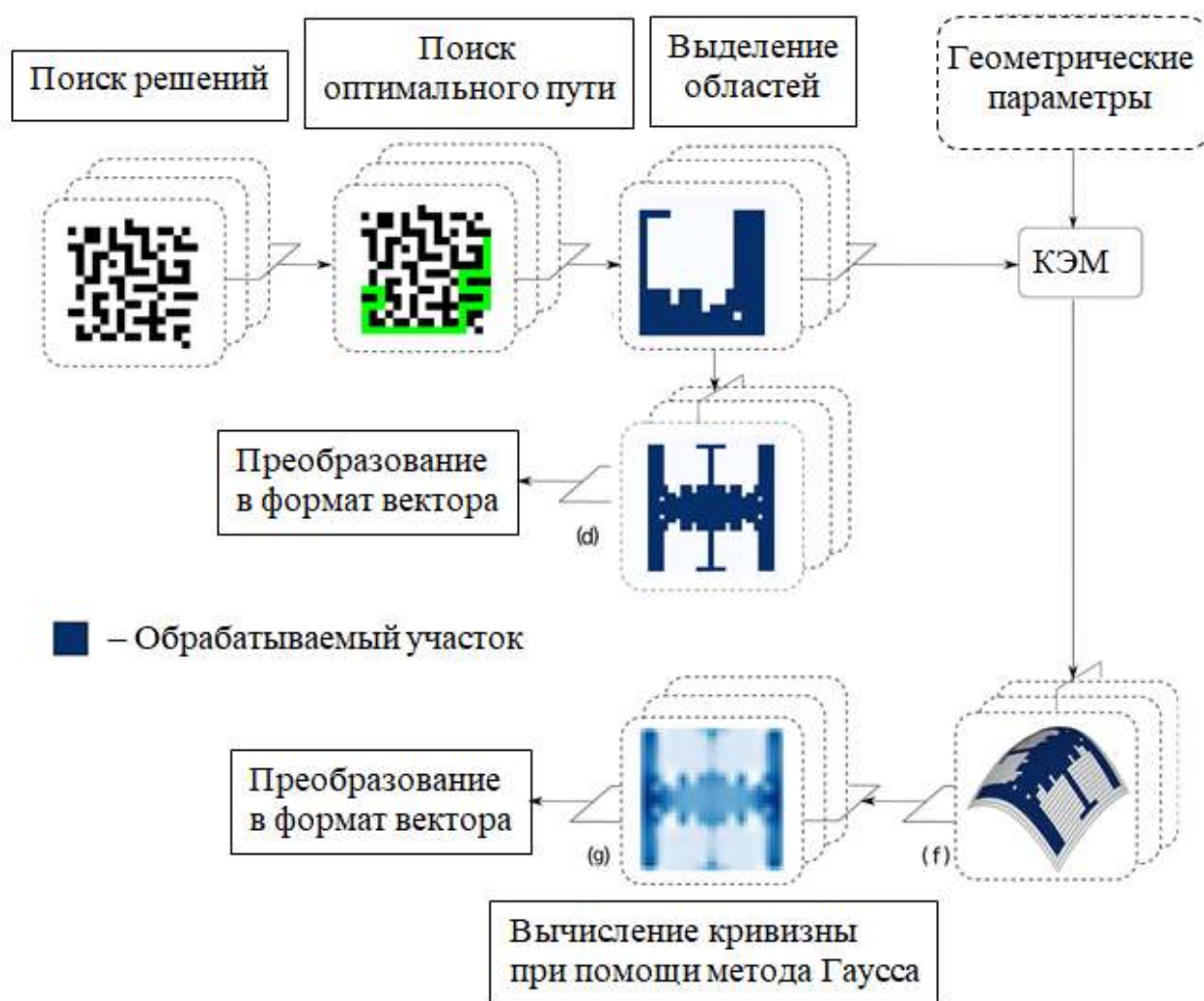
Рисунок 1.31 - Генерация траектории обработки на основе МО [134]
