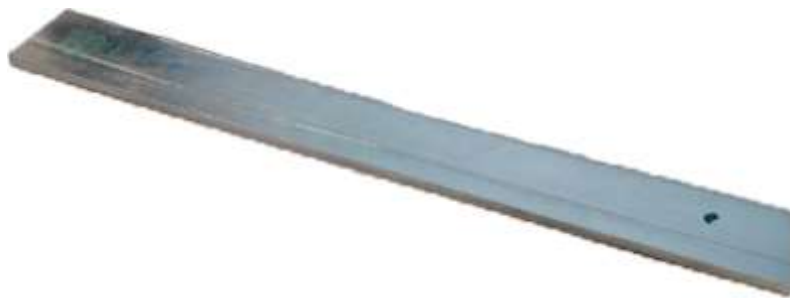
Рисунок 2.1 – Образец для проведения испытаний по определению механических свойств обрабатываемых деталей
