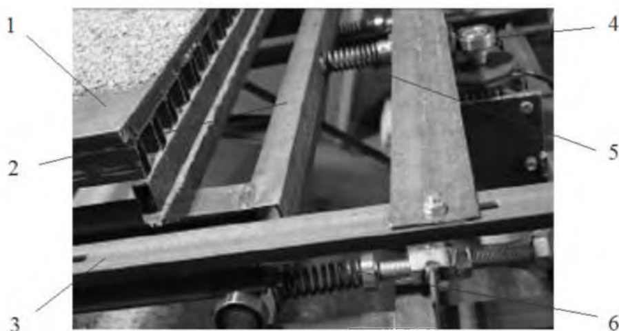
1- под, 2- платформа, 3- рама, 4- эксцентрик, 5- пружина толкателя, 6- пружина платформы
