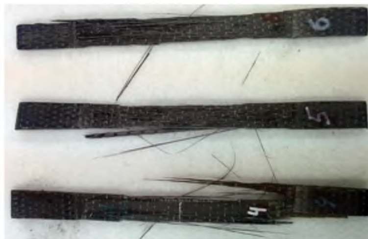
Рис. 4. Разрушение пластин под нагрузкой
