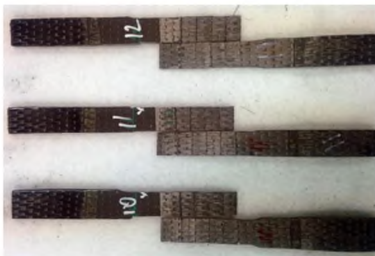
Рис. 6. Отремонтированные пластинки после разрыва
