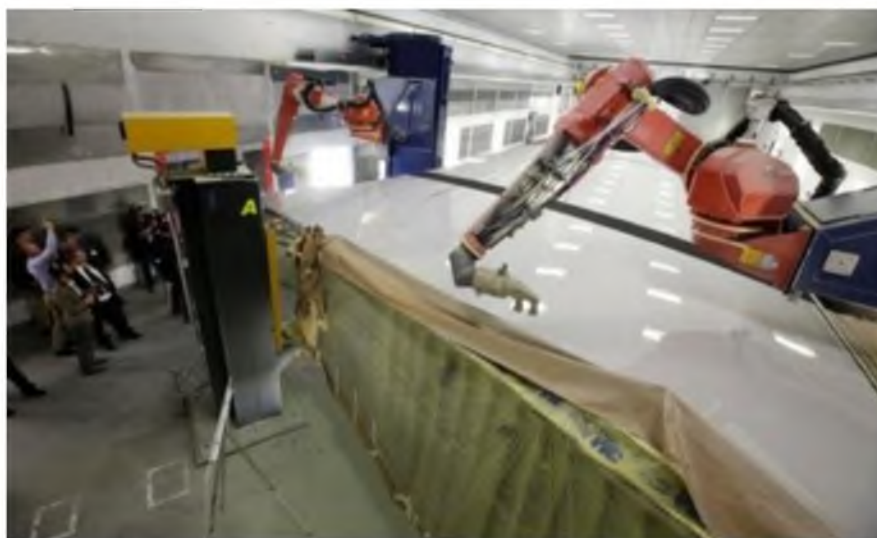
Рис. 2. Покраска панели крыла Боинг 777
