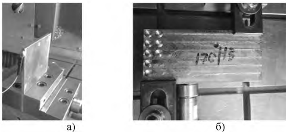
Рис. 1. Экспериментальные установки для модуляции частоты вращения шпинделя при: а) сверлении; б) концевом фрезеровании
