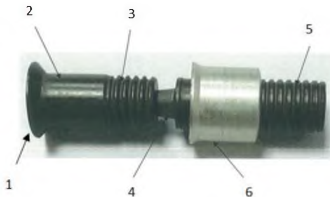
1 - закладная головка; 2 - гладкая часть; 3 - цилиндрическая часть с кольцевой накаткой; 4 - шейка; 5 - хвостовик с кольцевой накаткой, 6 – кольцо
