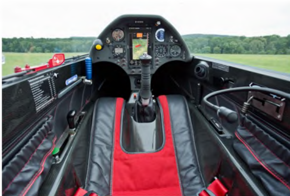
Рис. 6. Кабина планёра Ventus 3
