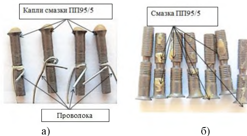
Рис. 3. Стержни болт-заклепок после окунания в технологическую смазку ПП95/5 с помощью: а) проволоки, б) сетчатой корзины
