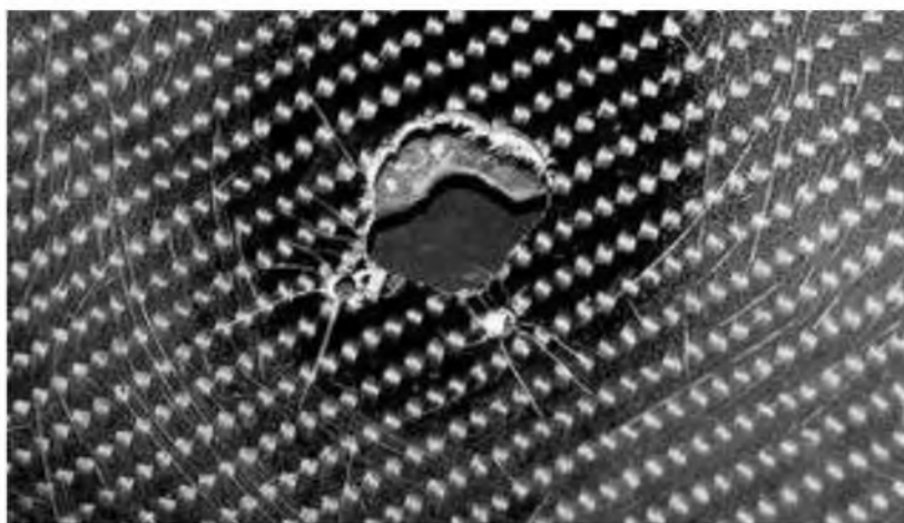
Рис. 2. Вид эксплуатационных повреждений обшивки планера
