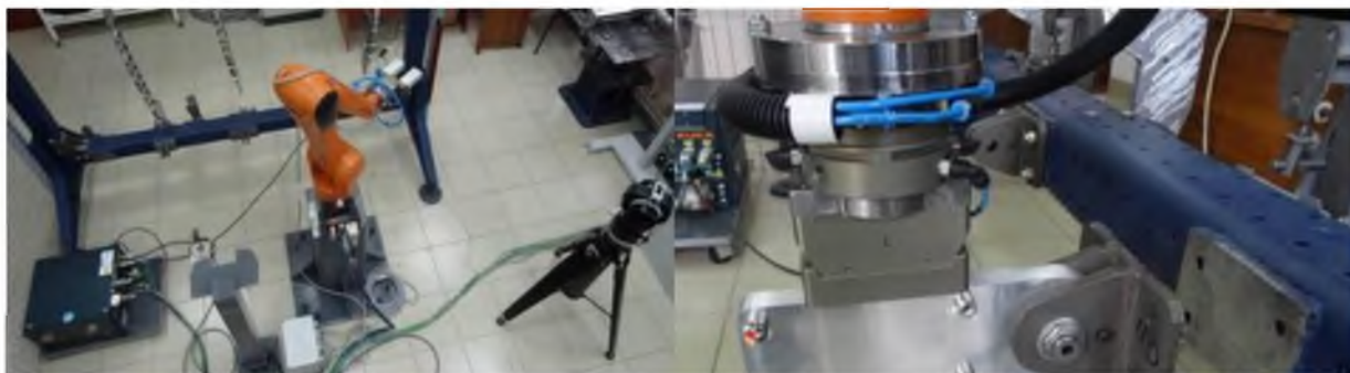
Рис. 4. Комплекс автоматизированного монтажа сборочной оснастки с использованием промышленного робота KUKA KR AGILUS SIXX
