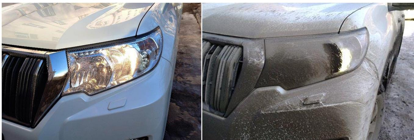
Рис. 7. Автомобиль Toyota Land Cruiser Prado с включенным дальним светом фар до и после движения по дороге, покрытой ХПГМ
