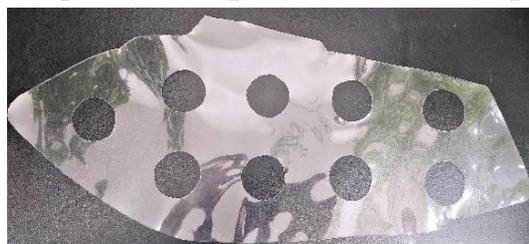
Рис. 6. Шаблон для оперативного позиционирования мест контроля светопропускания экрана
