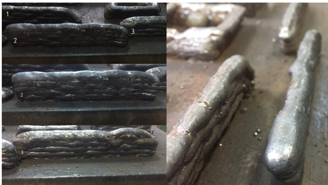
Рис. 3. Наплавленные стенки
