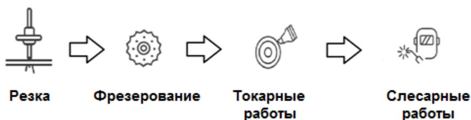
Рис.8. Традиционный технологический процесс изготовления импеллера
