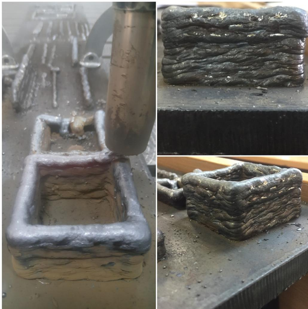
Рис.4. Образец коробчатого сечения
