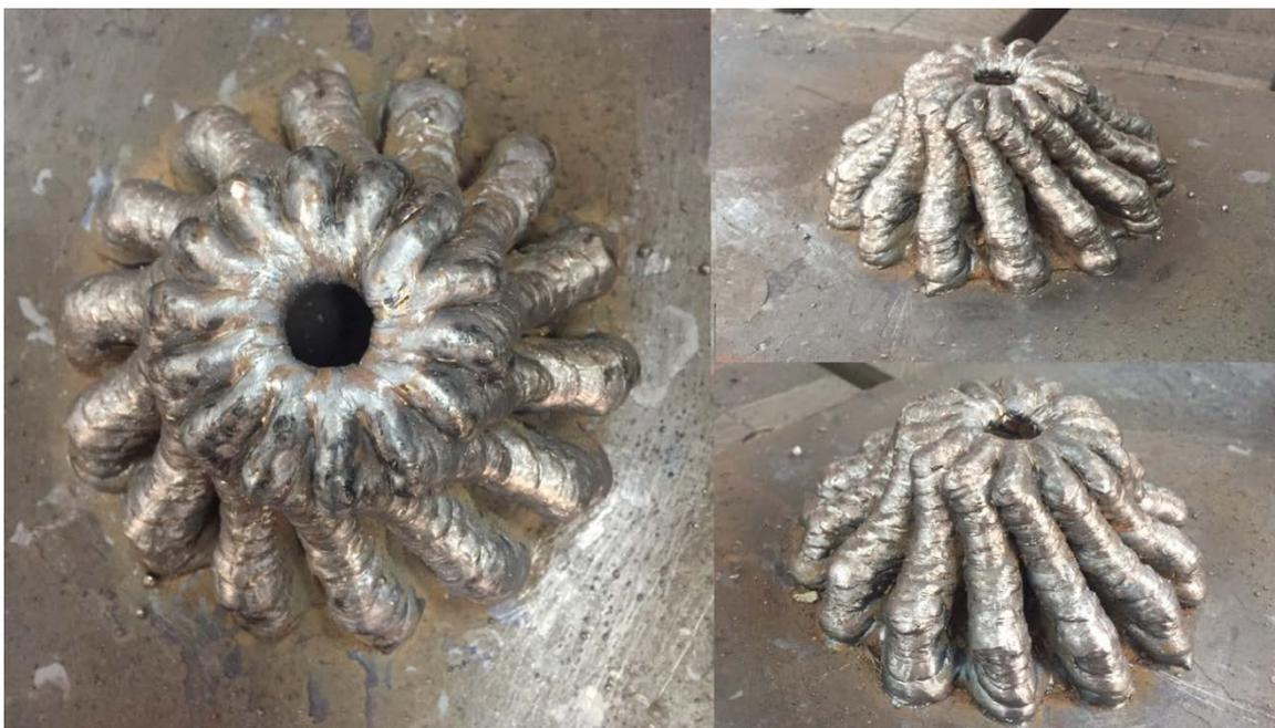
Рис.16. Напечатанный прототип имPELLера
