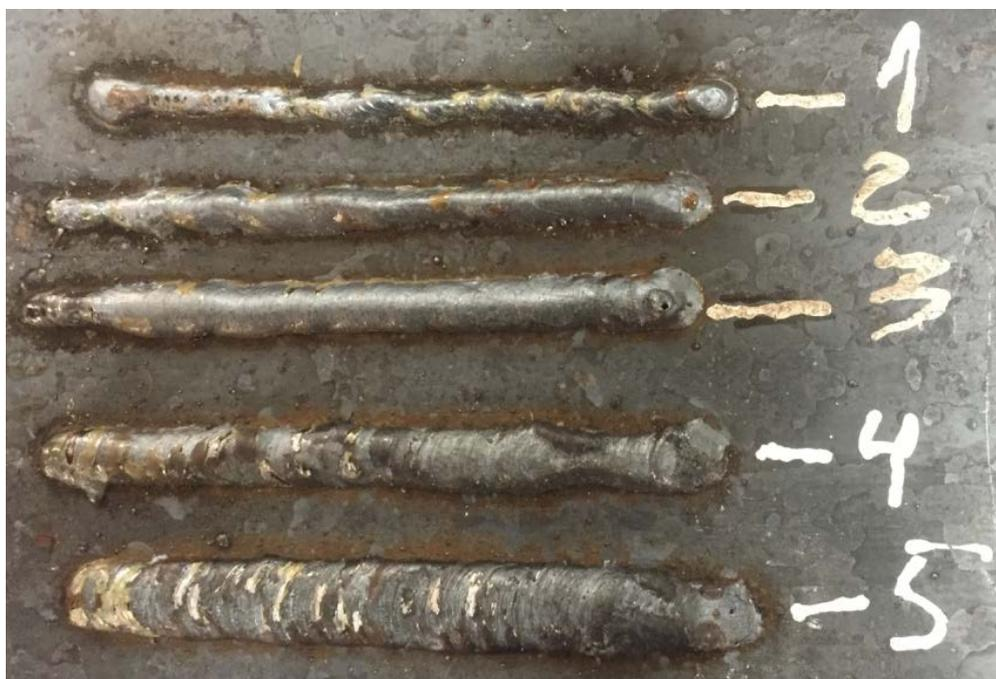
Рис. 2. Валики, наплавленные при разных режимах
