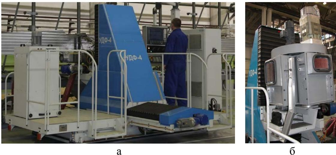
Рис. 1 – Установка УДФ-4, а) общий вид; б) зачистная головка револьверного типа
