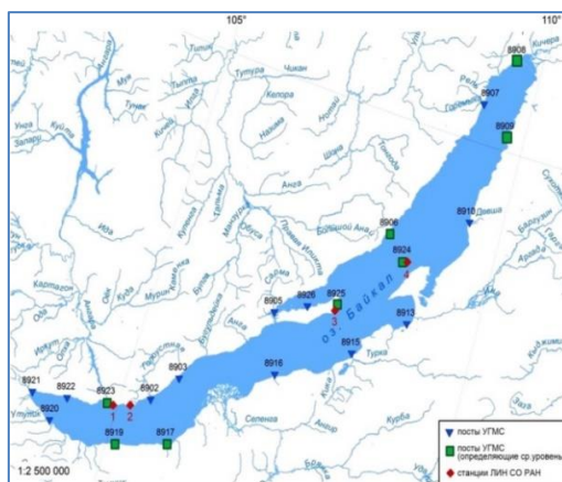
Рисунок 3. Схема гидропостов наблюдений уровневого режима озера УТМС
