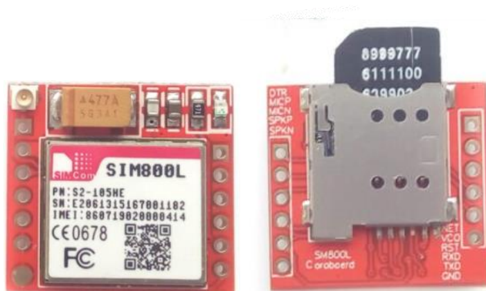
Рисунок 1 - Внешний вид модуля GSM, GPRS на чипе SIM800L
