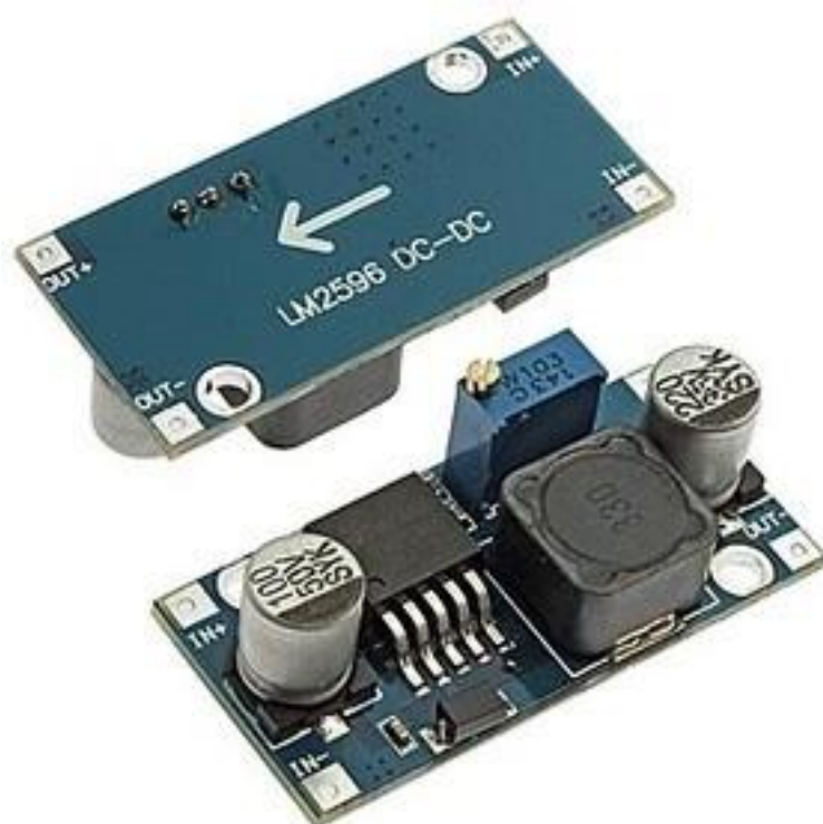
Рисунок 2 - Внешний вид преобразователя напряжения LM2596
