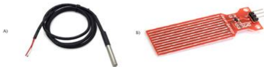
Рисунок 3. Датчик температуры DS18B20 (А) и датчик уровня воды Water Sensor (Б)
