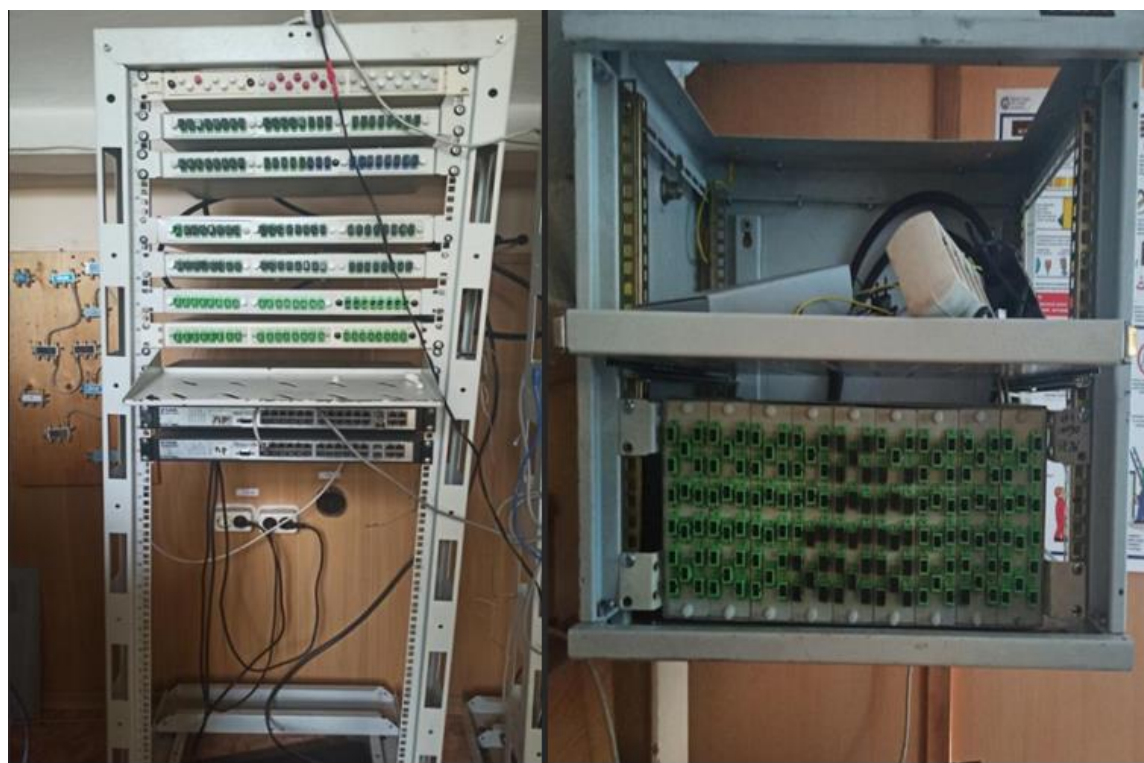
Рисунок 4– лабораторный стенд для изучения сети на пассивных оптических элементах для изучения технологии GPON
