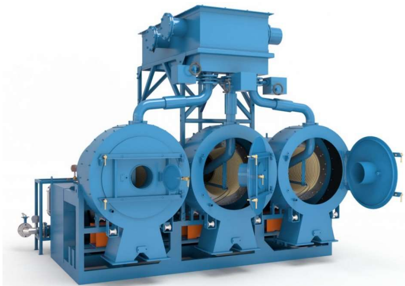
Рисунок 1.7 – Общий вид мультироторного комплекса «Итомак-КГ-100» на базе центробежных концентраторов «Итомак-КГ-40»
