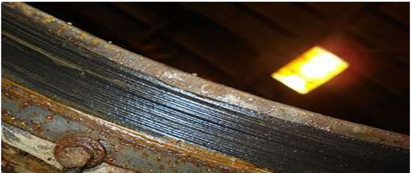
Рисунок 2.15 – Верхнее неподвижное кольцо гидроуплотнения ЦОМ после окончания стендовых испытаний.
