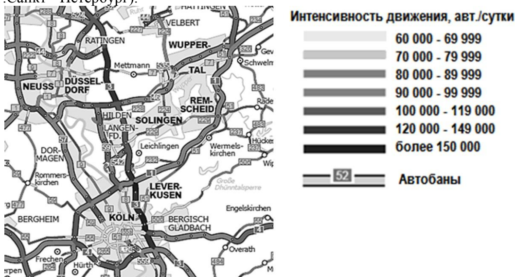
Рис. 1. Участок магистральной дорожной сети Рурской агломерации. На участках магистрали А3 (восточный обход Дюссельдорфа и Кельна) характерны значения интенсивности 100000 – 150000 авт./сутки
