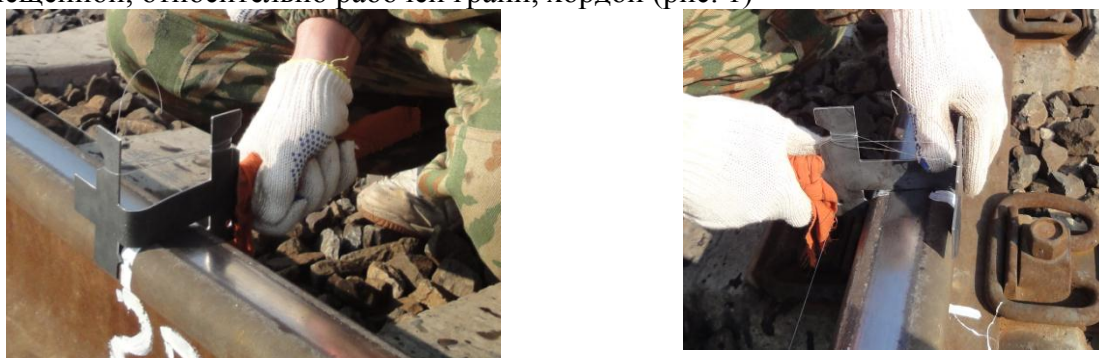
Рис. 1. Держатель хорды для измерений стрел изгиба
