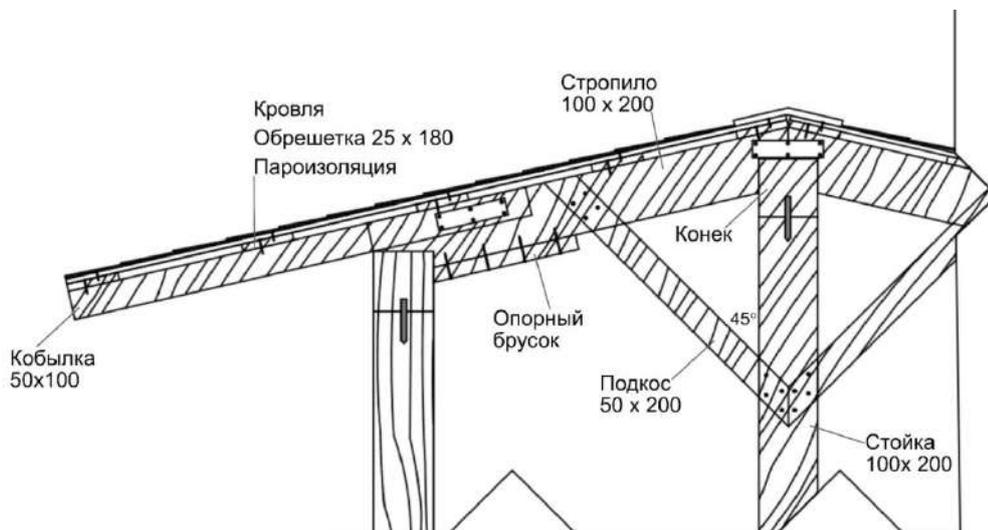
**Рисунок 30. Узел стропильной крыши каркасного здания**
