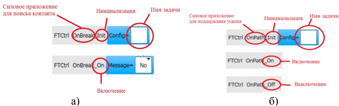
Рисунок 2 – Структура аббревиатуры силового приложения для поиска контакта с заготовкой (а) и для поддержания требуемого усилия (б).
