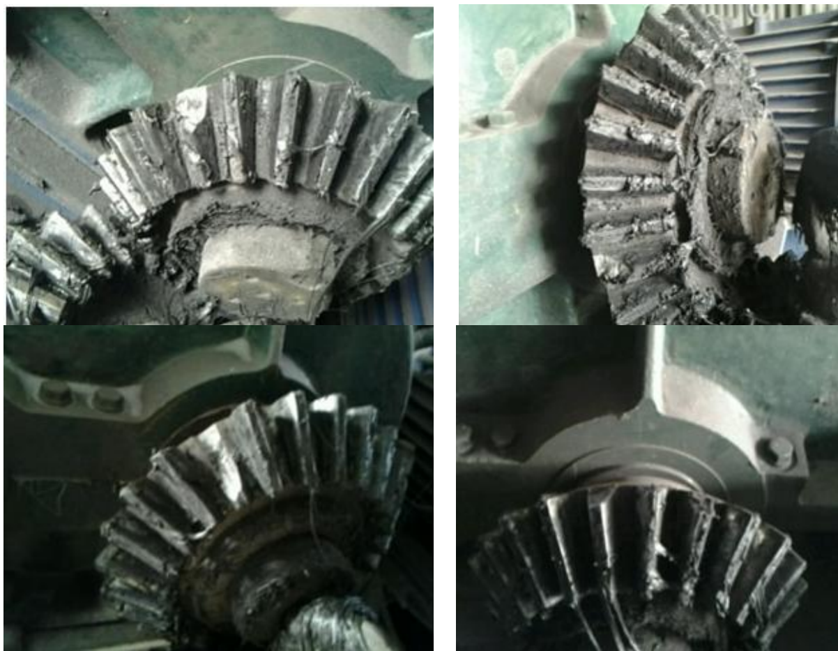
Рис. 2. Пример разрушения конической шестерни
