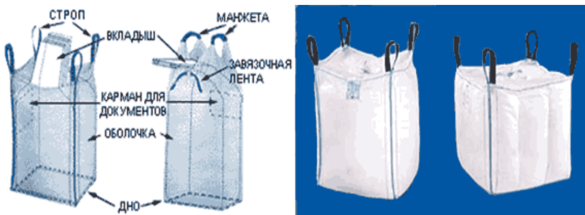
Рис. 2. Общий вид мягкого контейнера
