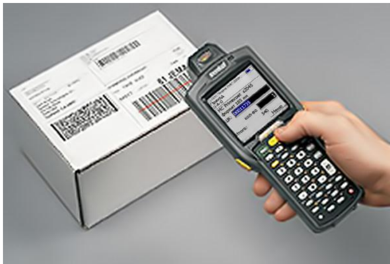
Рис. 4. Принцип работы штрихового кодирования
