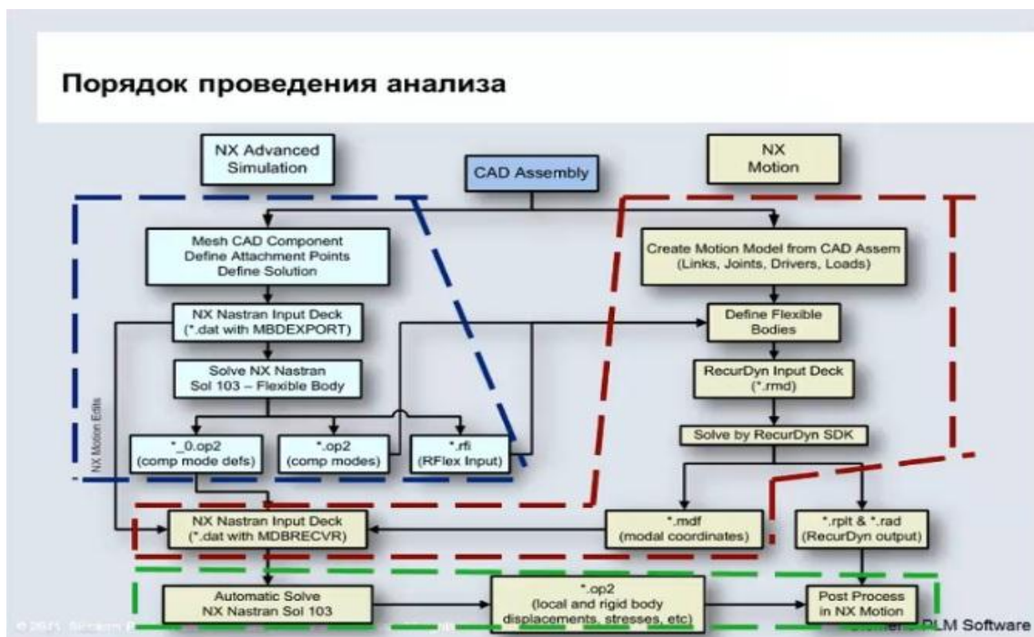
Рис. 3. Порядок проведения анализа на основе NX Motion и NX Advanced Simulation
