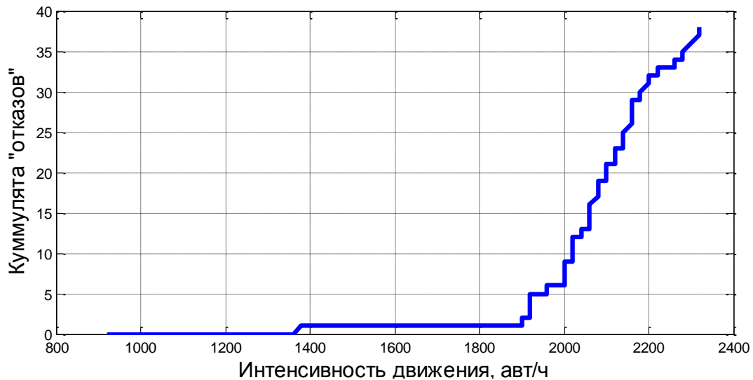
Рис. 2. Анализ «отказов» на подходе к Академическому мосту в г. Иркутске
