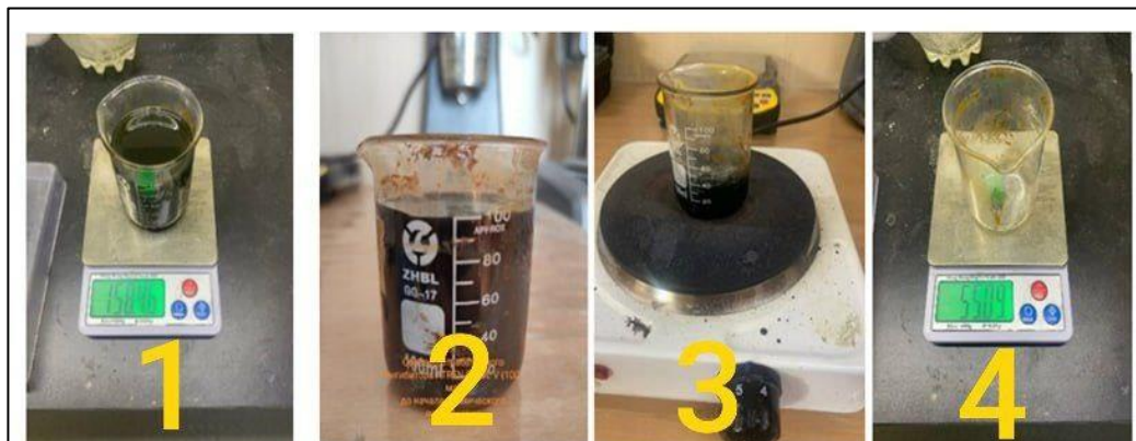
Рисунок 4. Исследование воздействия МЭА и h-iron на 90 минут термической коррозии на отобранные пробы забойной воды, насыщенной сероводородом до 80 ppm.
