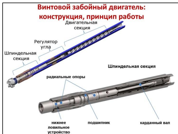
Рисунок 2. Винтовой забойный двигатель
