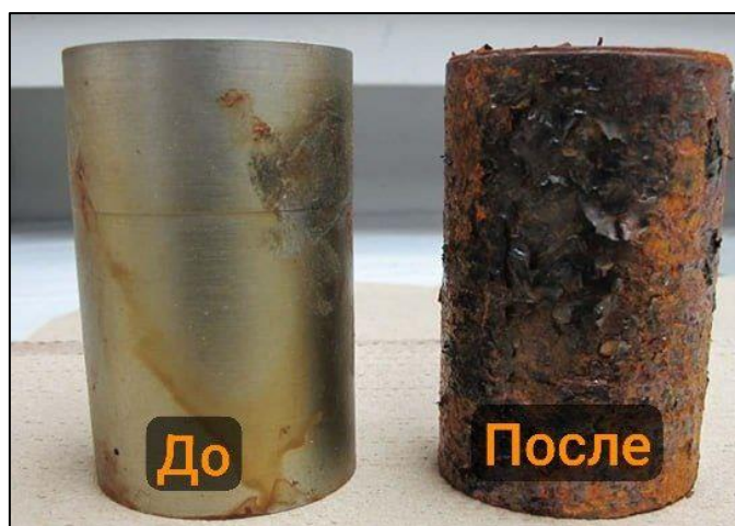
Рисунок 4. До и после освоение переводника НКТ 114,1 мм. Скорость коррозии за 6 часов при забойной условие
