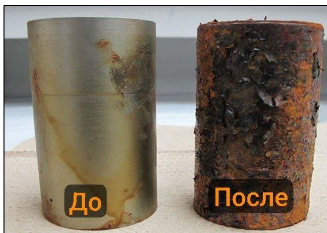
Рисунок 1. До и после освоение переводника НКТ 114,1 мм. Скорость коррозии за 6 часов при забойной условие
