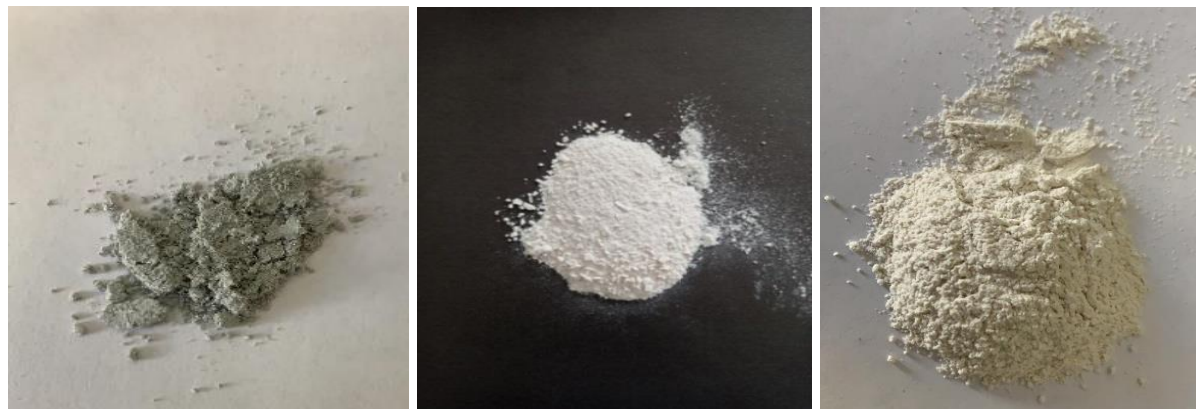
Рисунок 8 – Криолит, полученный из фторсодержащих растворов щелочно-ультразвуковой переработки фторсодержащего техногенного сырья
