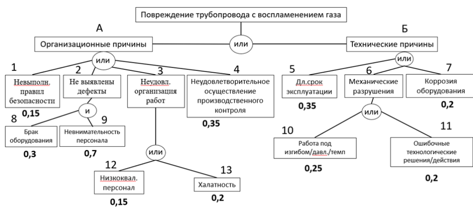
Рис. 3. Дерево происшествий «Повреждение трубопровода с воспламенением газа»
