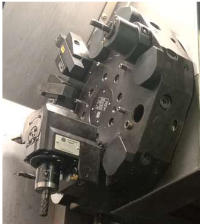
Рисунок 3.3 – Общий вид инструментального блока установленный в револьверную головку станка
