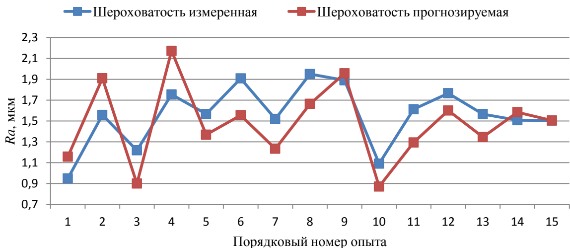
Рисунок 4.4 – График сходимости измеренной и рассчитанной шероховатости поверхности
