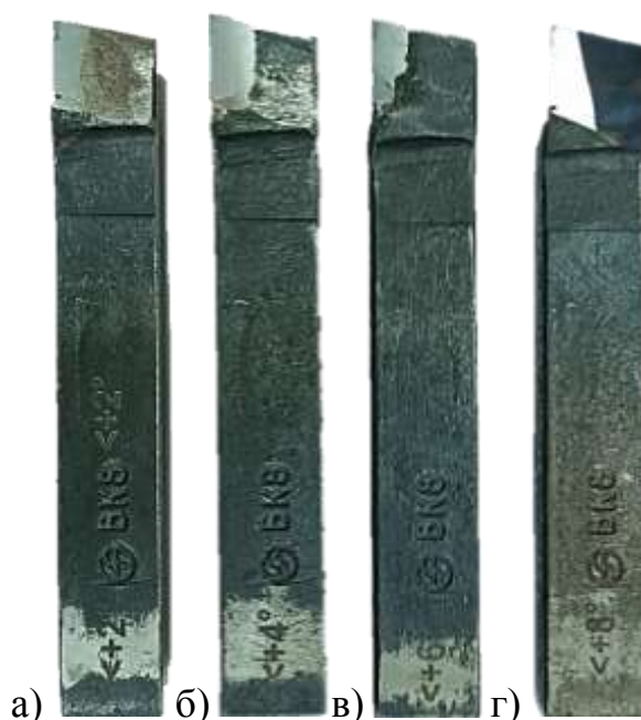
Рисунок 3.10 – Проходные упорные резцы с напайными пластинами из твердого сплава BK8 с измененным задним углом:
