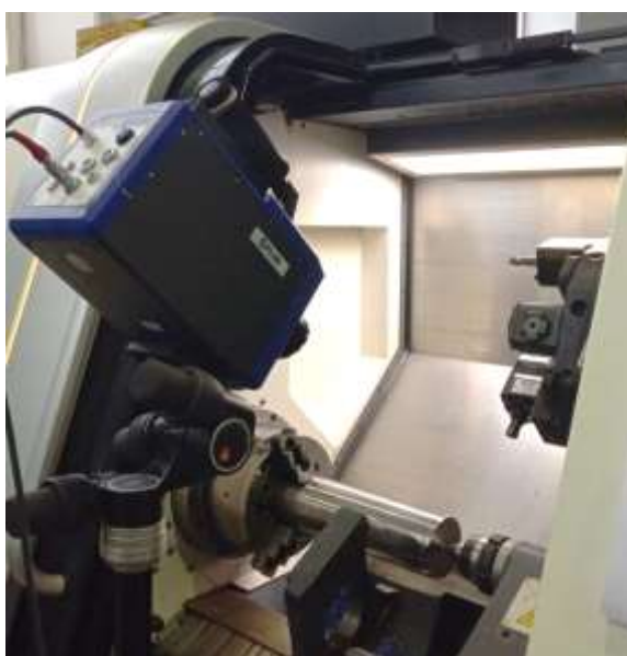
Рисунок 3.13– Тепловизионная камера Flir Orion установленная перед проведением эксперимента
