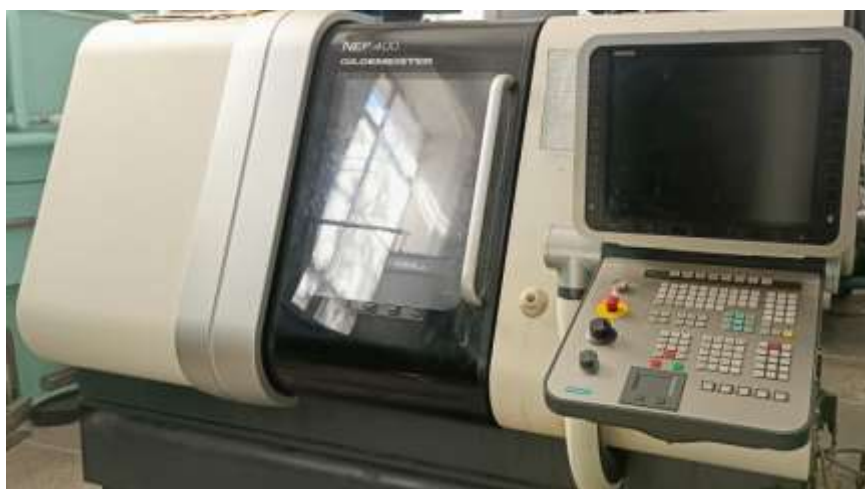
Рисунок 3.1 – Токарный обрабатывающий центр DMG NEF400
