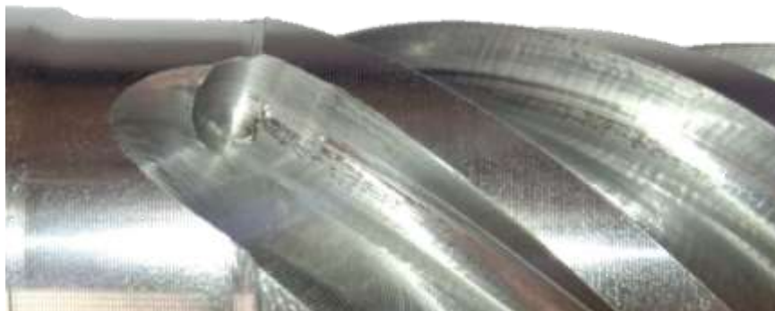
Рисунок 4.20 – Стружечные канавки, полученные фасонным пятиосевым фрезерованием на многозадачном обрабатывающем центре с ЧПУ
