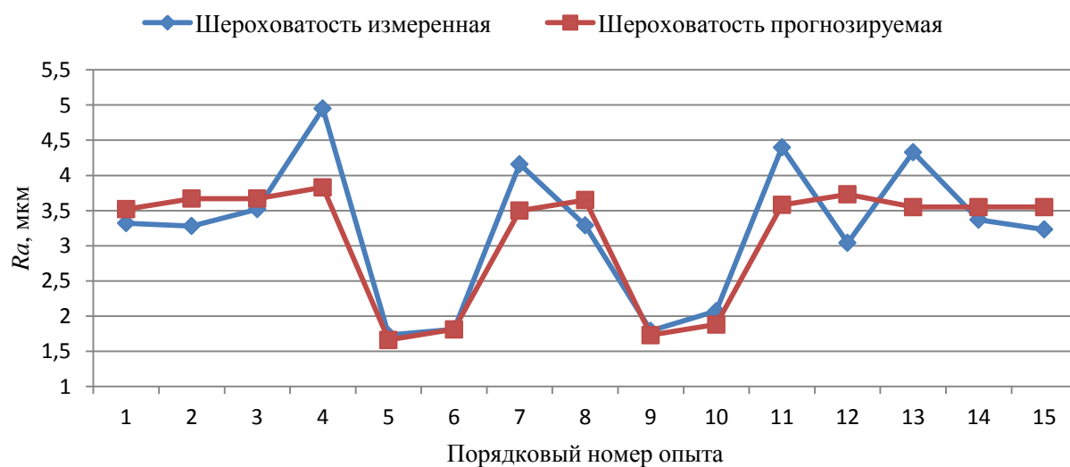
Рисунок 4.1 – График сходимости измеренной и рассчитанной шероховатости поверхности
