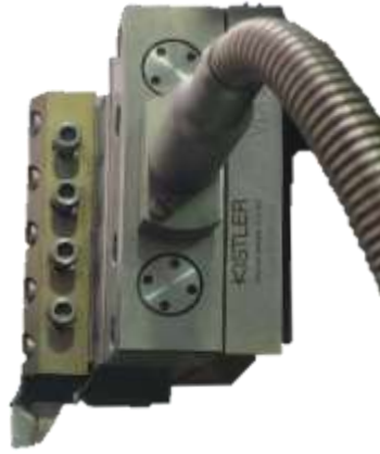
Рисунок 3.16 – Динамометр для токарных станков Kistler 9129AA в сборе с резцом
