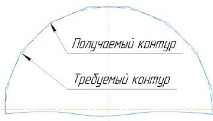
Рисунок 2.13 – Поперечное сечение заготовки, получаемой при ортогональном фрезоточении
