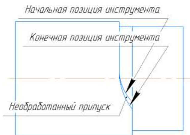
Рисунок 1.7 – Необработанный припуск после тангенциального фрезоточения
