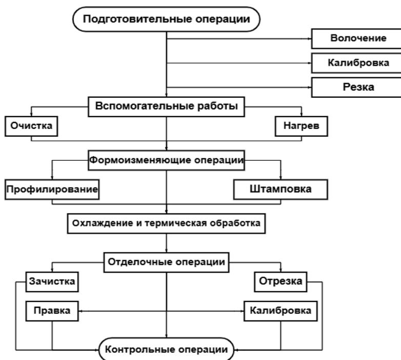
Рис. 1. Блок-схема производственных процессов кузнечно-литейного цеха
