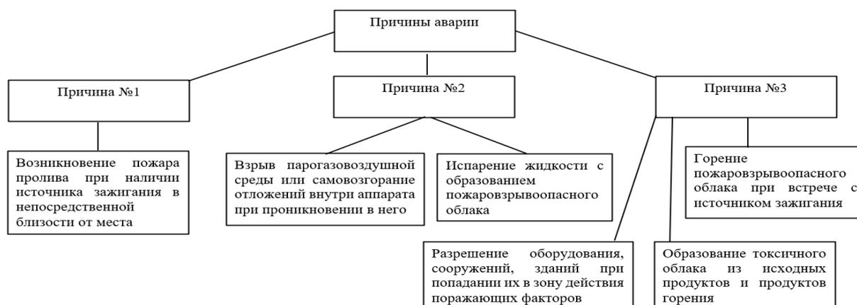
Рис. 1. Дерево возможных причин аварий на АЗС
