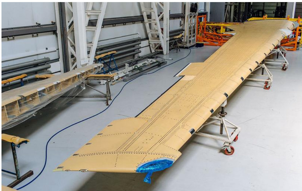
Рисунок 3. Кессон крыла самолета МС-21 из российских полимерных композиционных материалов прошел этап статических испытаний в ЦАГИ им. Н.Е. Жуковского.
