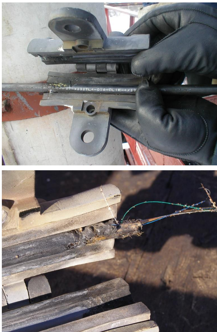
Рисунок 3. Повреждение оболочки кабеля в торцевой части зажима ЗП-14 (сверху), и полное разрушение защитных оболочек и элементов конструкции кабеля (снизу) в результате воздействия наведённого напряжения.
