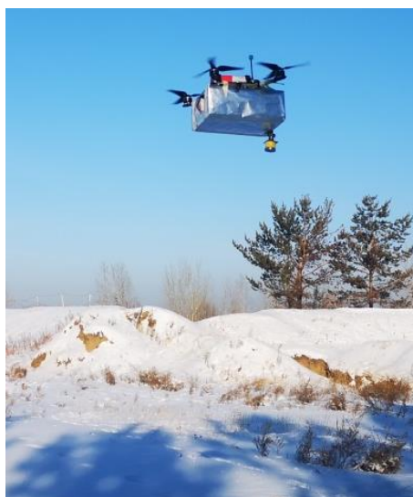
Рисунок 1. Фотография радиометра на длину волны 0,8 см, установленного на БПЛА
