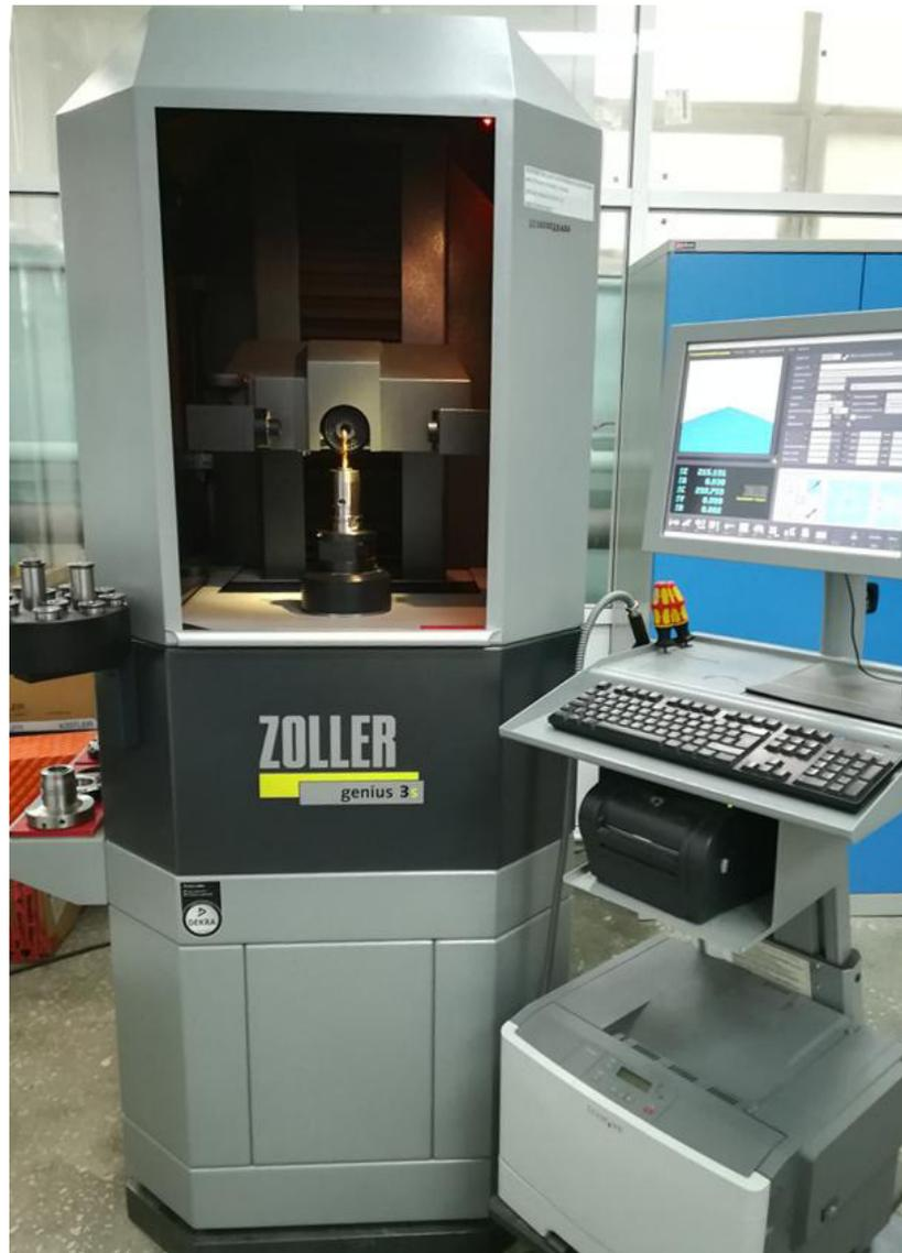
Рисунок 4.5 – Измерение геометрических параметров сверла на устройстве для контроля и настройки режущего инструмента вне станка Zoller Genius Pilot 3s
