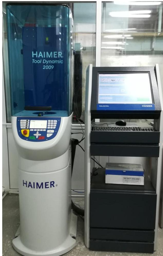
Рисунок 3.8- Балансировочная машина Haimer Tool Dynamic 2009
