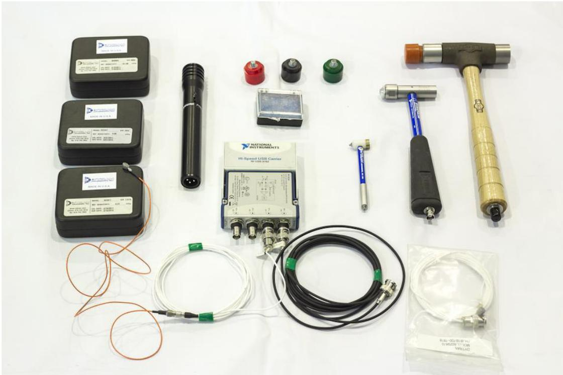
Рисунок 2.11 – Комплекс для проведения модального анализа
