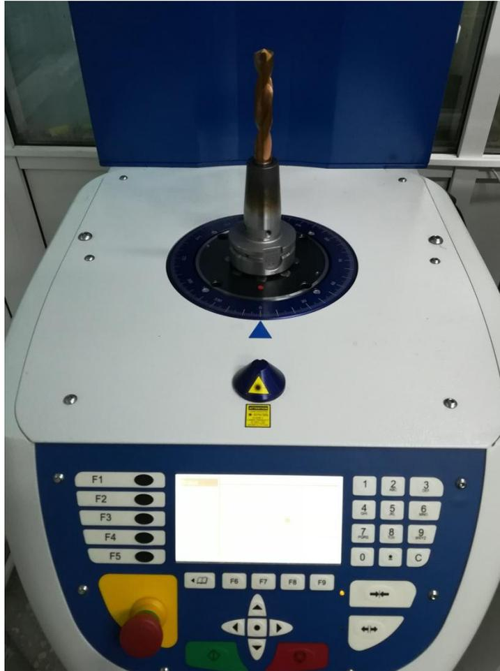
Рисунок 3.14 – Проверка динамического дисбаланса
