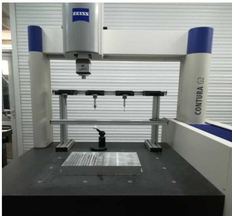
Рисунок 4.16 – Измерение диаметральных размеров отверстий на координатно–измерительной машине Contura G2
