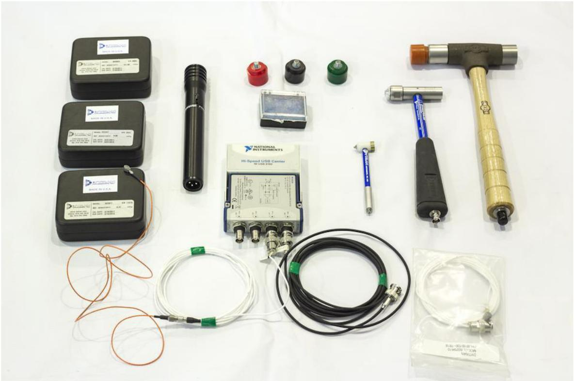
Рисунок 4.25 – Комплекс для проведения модального анализа
