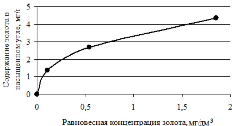
Рисунок 4.2 – Изотерма сорбции золота регенерированным активным углем GR-150, полученная при цианировании продукта известково-кислородного окисления
