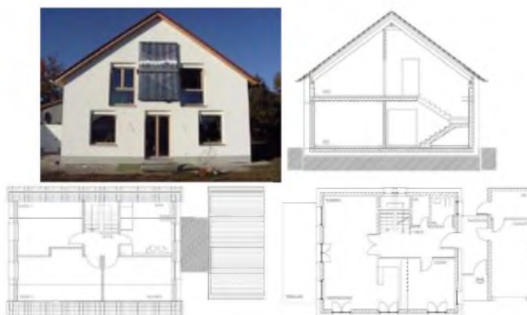
Рис. 1. План 1, 2 этажа и разрез частного энергоэффективного дома
