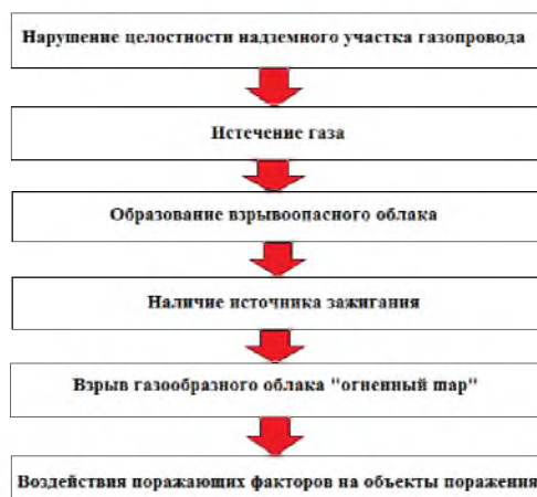
Рис. 2. Этапы развития аварии на газопроводе
