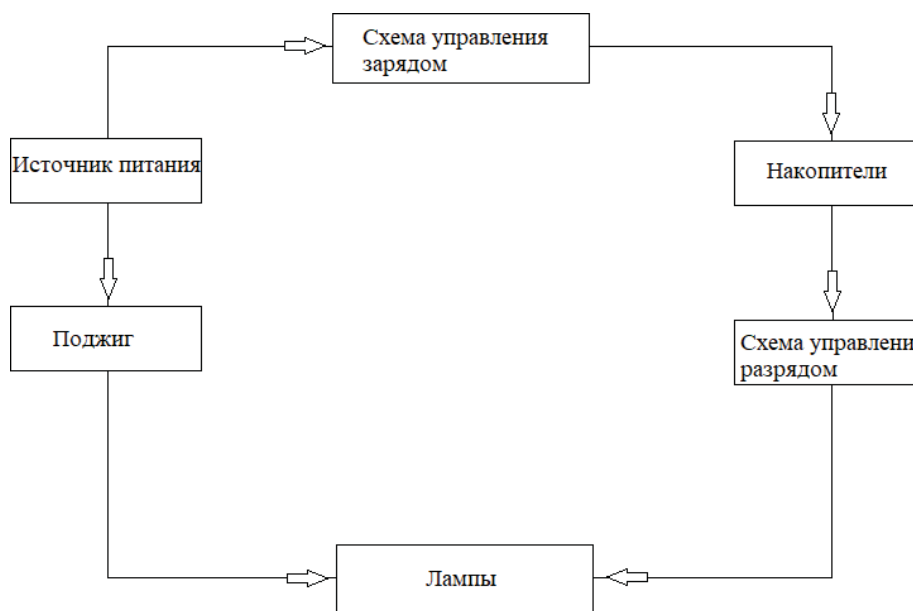
Рисунок 1 – Функциональная электрическая схема устройства ОКГ
