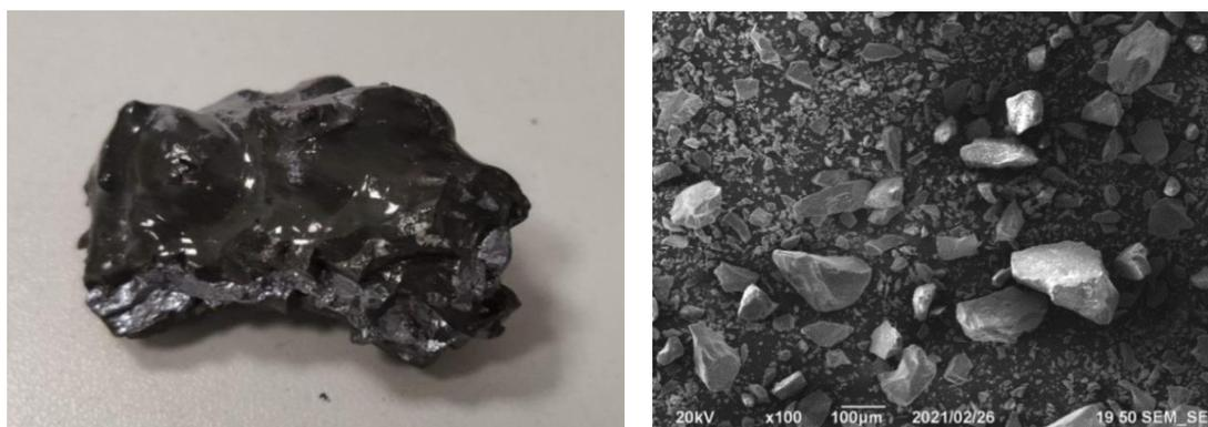
Рисунок 1 – Рафинировочный шлак АО «Кремний»: *а* – общий вид; *б* – фото измельченного образца шлака (сканирующая электронная микроскопия, увеличение  $\times 100$ , микроскоп JIB-Z4500 («Jeol», Япония))
