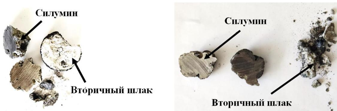
Рисунок 8 – Продукты плавки: Al-Si сплав и вторичный шлак
