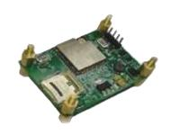
лис-и Инклинометр. «Умная сеть» геодинамического мониторинга объектов строительства
