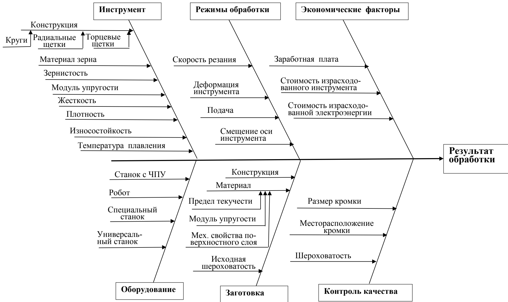
Рисунок 2.4 – Причинно-следственная диаграмма процесса финишной обработки (схема Исикавы)
