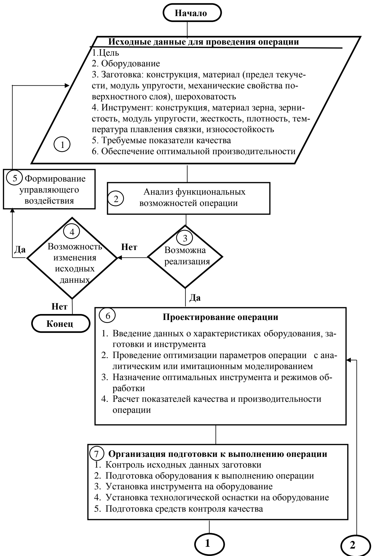
Рисунок 2.3 – Алгоритм функционирования системы, процессов и подпроцессов операции
