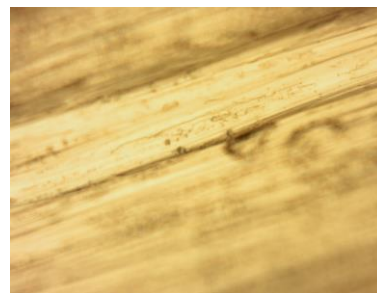
Щетка: Scotch-Brite™ Bristle BD-ZB P50 Режимы: n=500 \text{ мин}^{-1} ; \Delta Y=1,5 \text{ мм} ; S=130 \text{ мм/мин}
