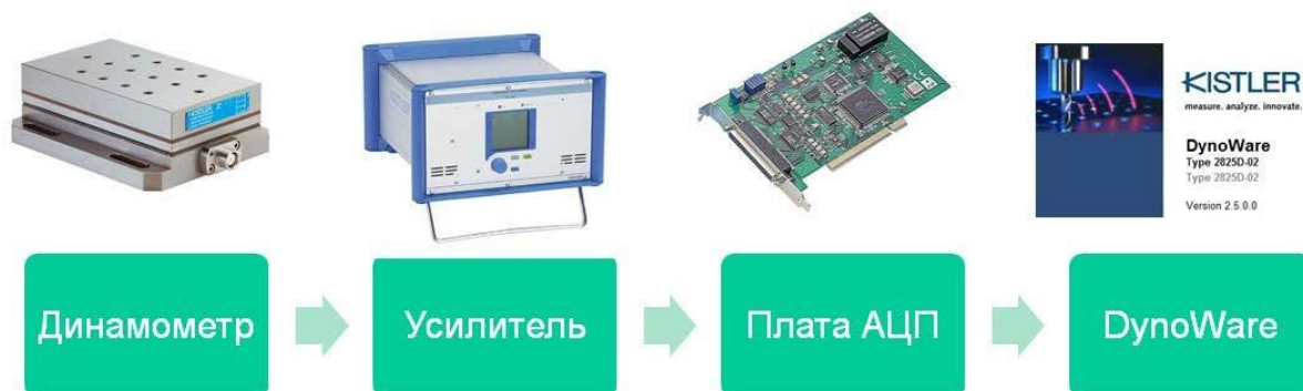
Рисунок Д.1 - Схема подключения динамометра [244]
