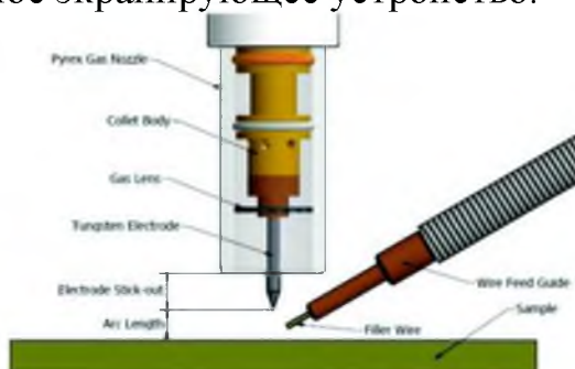
Рис. 9Схема горелки для GTAW [10]
