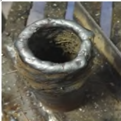
Рис.12.Аддитивная технология WAAM в CO 2 для получения детали в виде цилиндра
