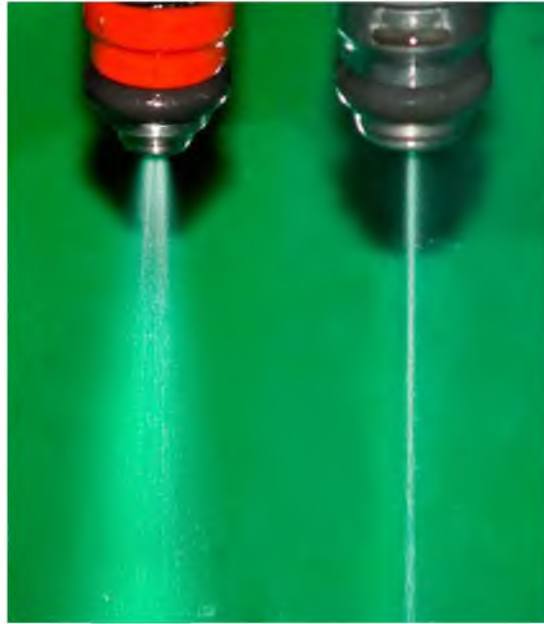
Рис. 3. Правильный и неправильный распыл форсунок
