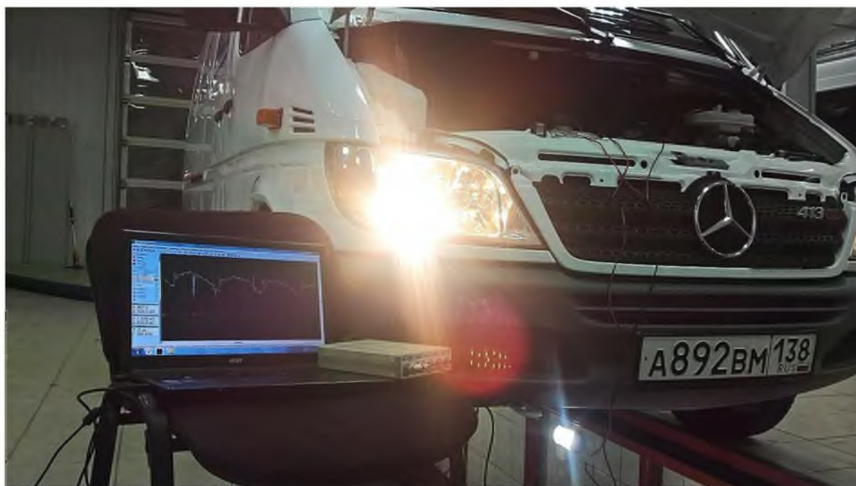
Рис. 2. Подключение приборного комплекса к двигателю автомобиля Mercedes-Benz Sprinter Classic
