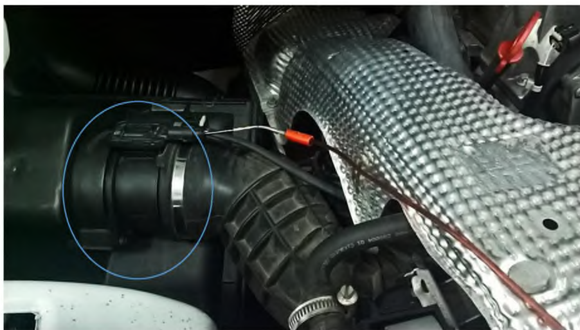
Рис. 3. Подключение щупа осциллографа к датчику массового расхода воздуха автомобиля Mercedes-Benz Sprinter Classic
