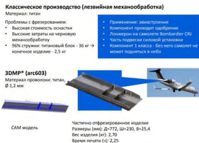
Рис.5. Титановый лонжерон изготовленный WAAM
