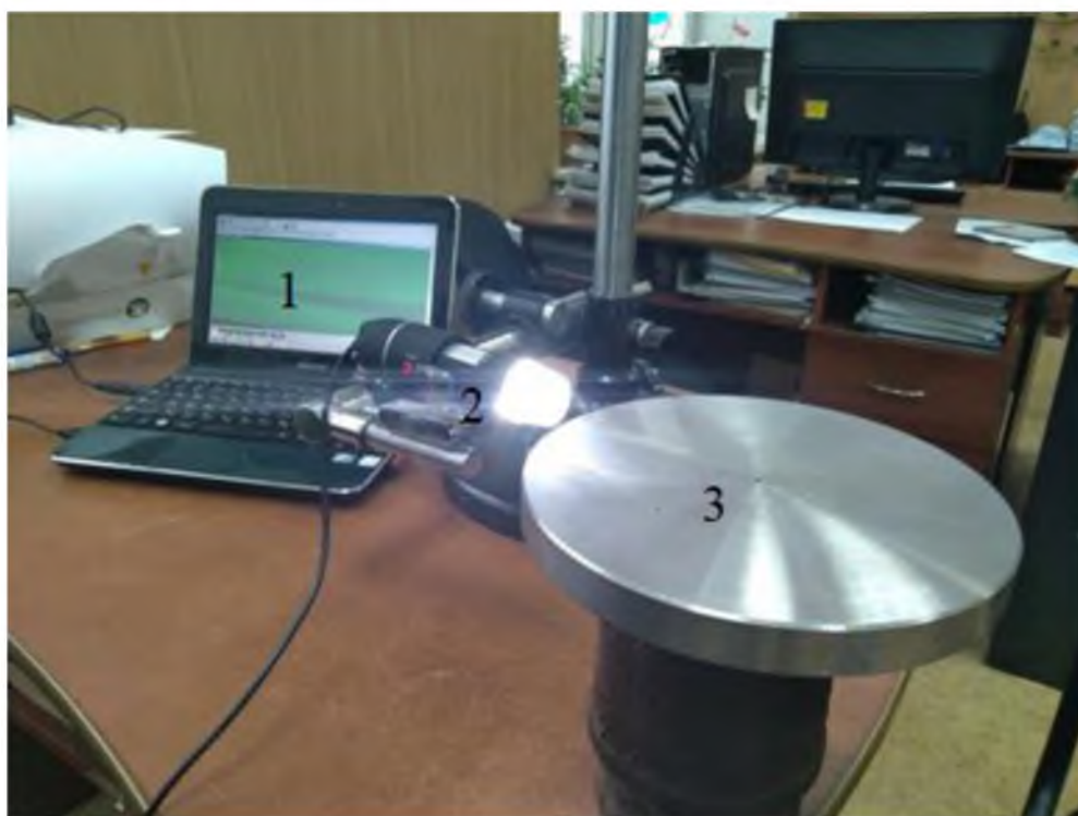
Рис. 2. Схема установки. 1 – Компьютер, 2 – Цифровой микроскоп, 3 – Поверхность исследования
