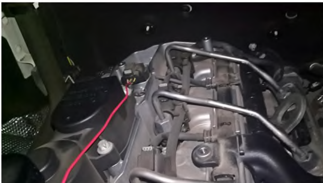
Рис. 4. Подключение к датчику положения распределительного вала автомобиля Mercedes-Benz Sprinter Classic
