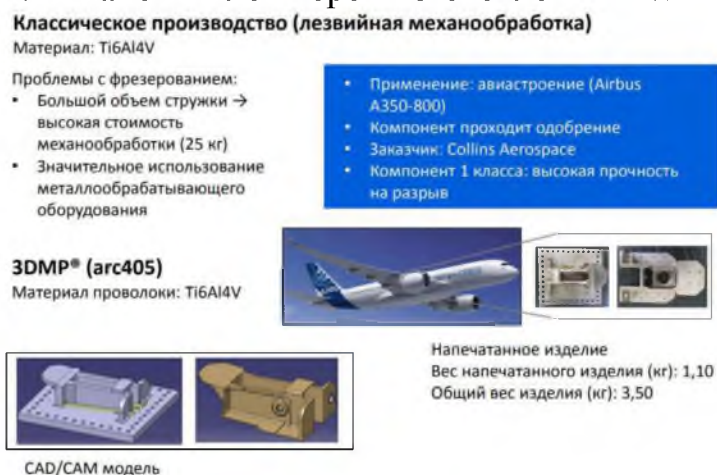
Рис.5. Титановый лонжерон изготовленный WAAM
