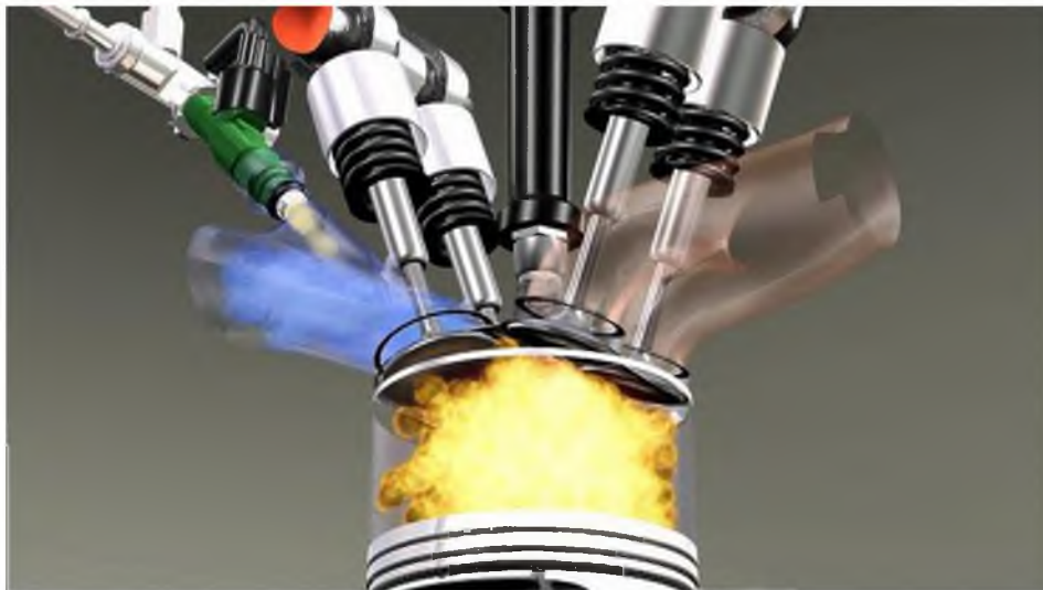
Рис. 4. Воспламенение горючей смеси в цилиндре двигателя внутреннего сгорания
