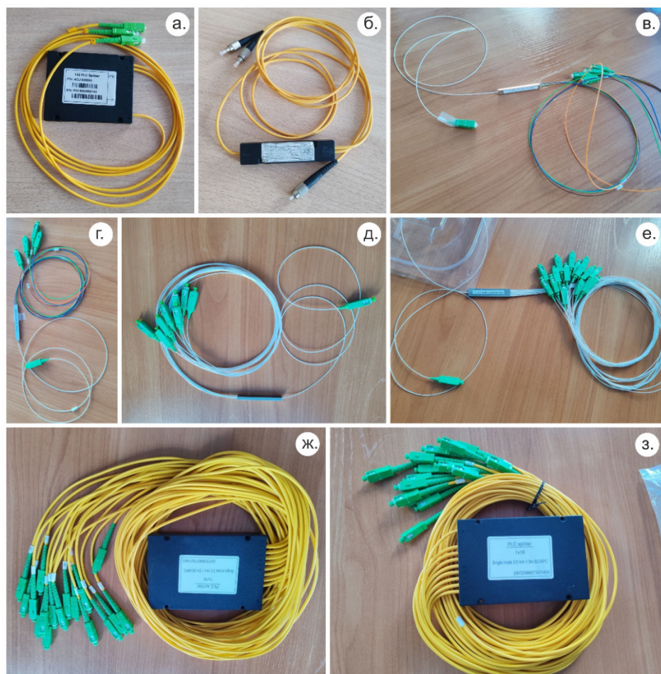
Рисунок 2. Сплиттеры, которые подвергались анализу: а, б) 1x2; в, г) 1x4; д) 1x8; е, ж, з) 1x16
