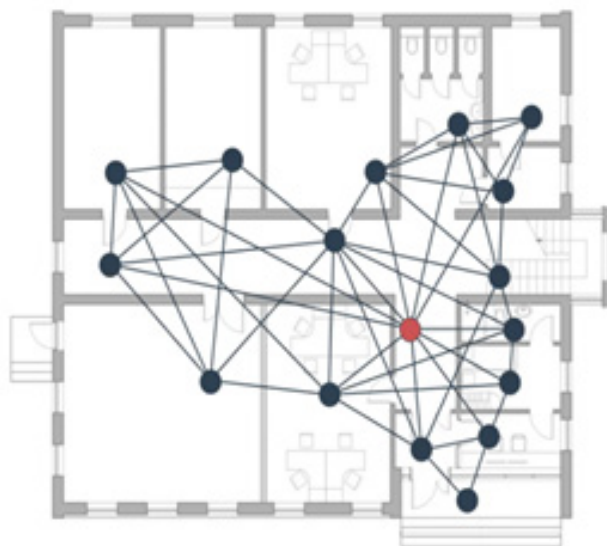
Рисунок 2. Распространение сигнала протокола ZigBee в mesh-топологии
