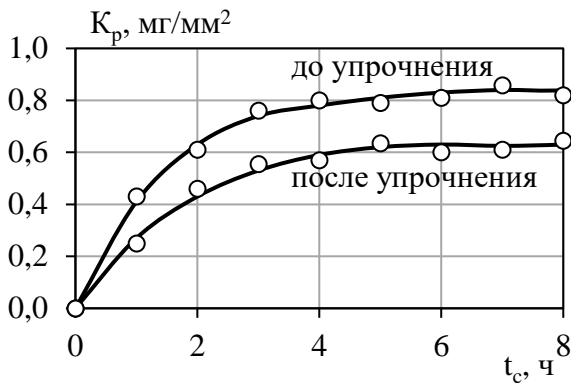
Рисунок 12 – Интенсивность коррозионного процесса образцов из стали 45 в 15% растворе серной кислоты
