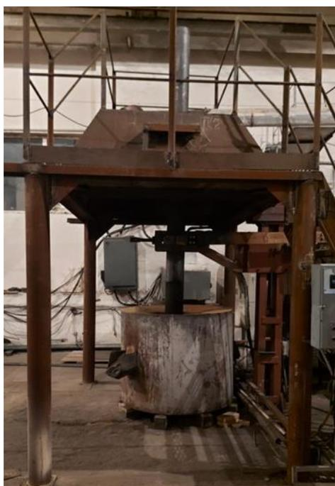
Рисунок 7 – Общий вид одноэлектродной печи на 250 кВ·А (КарИУ)
