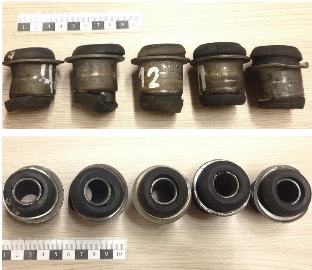
Рис. 4.3. Внешний вид сайлентблоков OEM 2101-2904043 с измененными функциональными свойствами.
