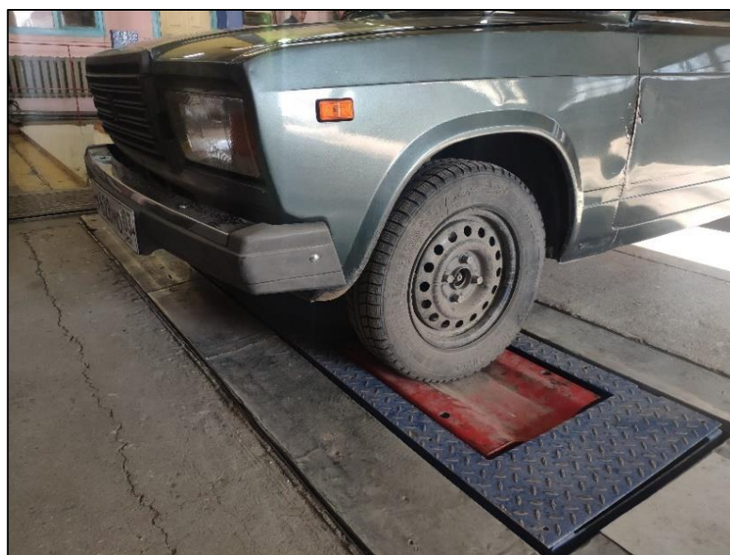
Рис. 4.8. Общий вид автомобиля ВАЗ 2107 на вибростенде по методу « EuSAMA ».
