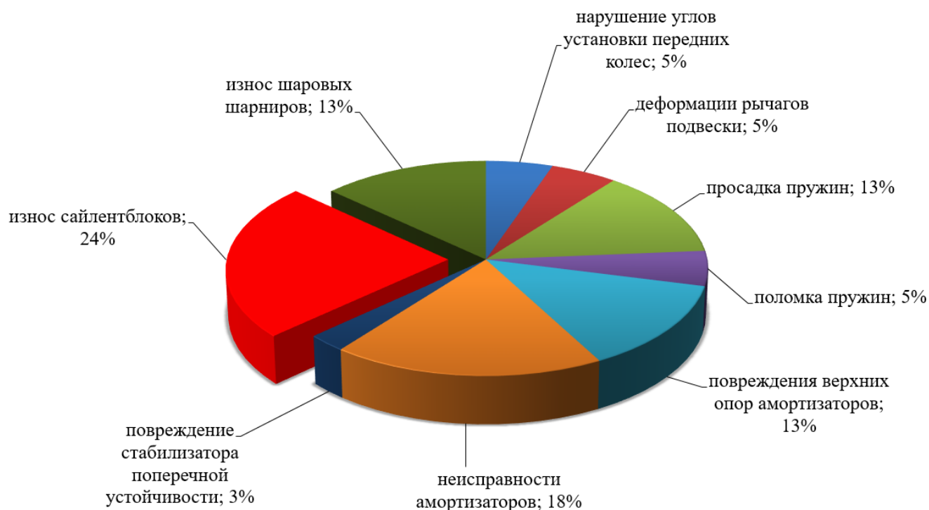
Рис. 1.7. Диаграмма распределения отказов элементов подвески автомобилей.
