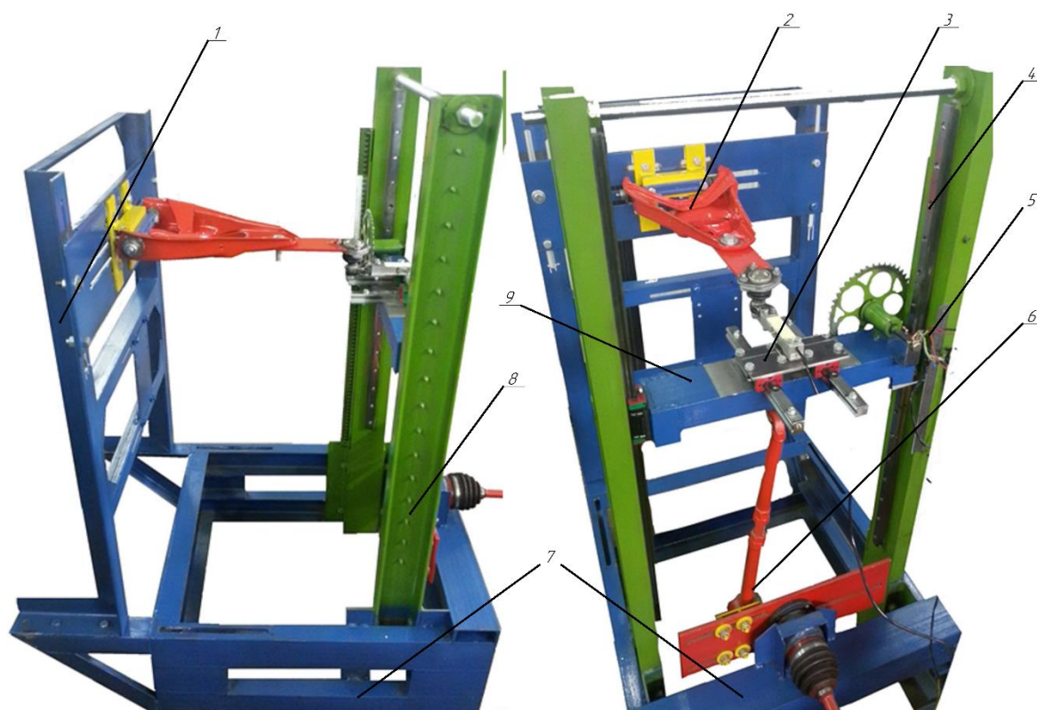
Рис. 3.4. Внешний вид составной части станда с установленными элементами: 1 – стойка для установки рычага; 2 – рычаг подвески с испытуемыми сайлентблоками; 3 – согласующее устройство; 4 – направляющая рельса ползуна; 5 – датчик перемещения; 6 – кривошипно-шатунный механизм; 7 – рама; 8 – основание для установки рельсы; 9 – ползун.
