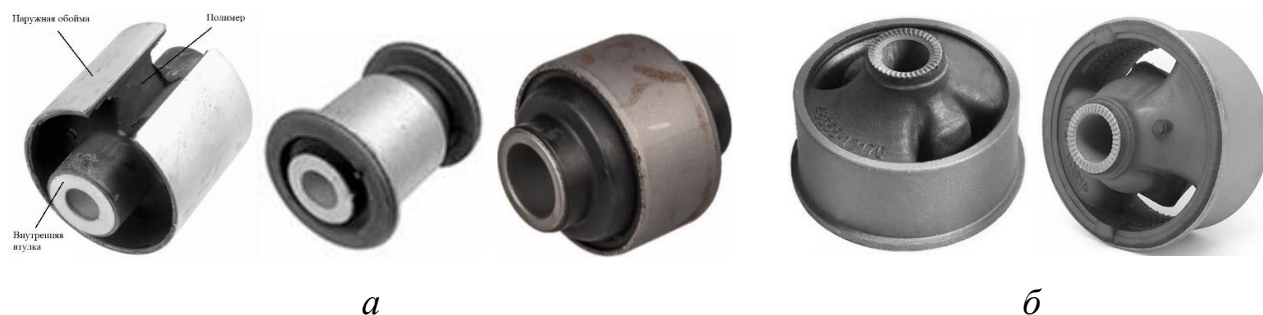
Рис. 1.6. Сайлентблоки подвески автомобиля: а – сайлентблоки работающие на кручение, б – податливые сайлентблоки (компенсационные).
