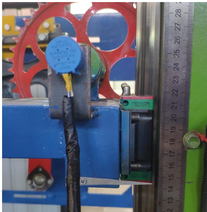
Рис. 3.11. Процесс тарировки системы измерения перемещения
