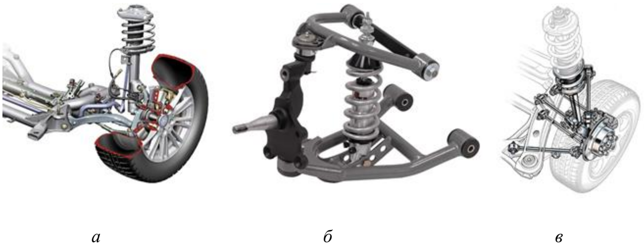
Рис. 1.3. Типы независимых подвесок ТС: а – подвеска MacPherson; б – подвеска на двойных поперечных рычагах; в – многорычажная подвеска.
