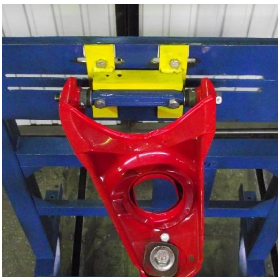
Рис. 4.1. Сайлентблок OEM 2101-2904043 в составе рычага подвески установленный на стенд.
