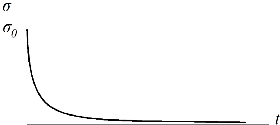
Рис. 1.20. Зависимость напряжения при постоянной деформации от времени (кривая времени релаксации).
