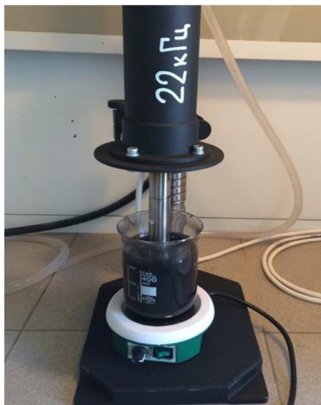
Рисунок 3.1 – Установка для выщелачивания фтора из образца угольной части ОФЭ
