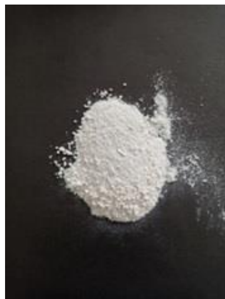
Рисунок 3.21 – Фотографии образцов полученного криолита из фторсодержащих растворов УЗ переработки проб угольной части ОФЭ и лежалого шлама при различных их соотношениях: a – 3:1; б – 1:1
