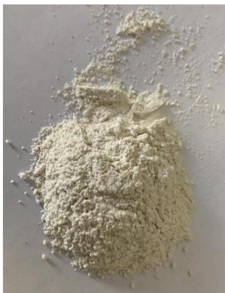
Рисунок 3.21 – Фотографии образцов полученного криолита из фторсодержащих растворов УЗ переработки проб угольной части ОФЭ и лежалого шлама при различных их соотношениях: a – 3:1; б – 1:1
