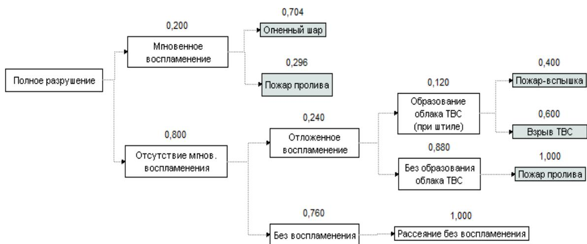
**Рис. 2. Дерево событий аварийной ситуации «Полное разрушение емкости, содержащей горючее вещество под давлением»**
