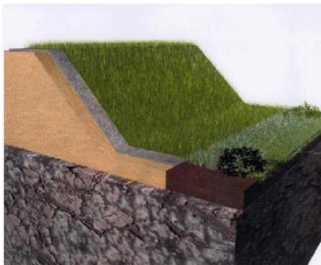
*Рис. 4. Закрепление грунтов биоматами на откосах насыпи*
