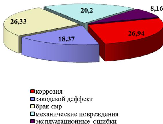
**Рис. 1. Данные об авариях на нефтепроводе ОАО «АК Транснефть»**
