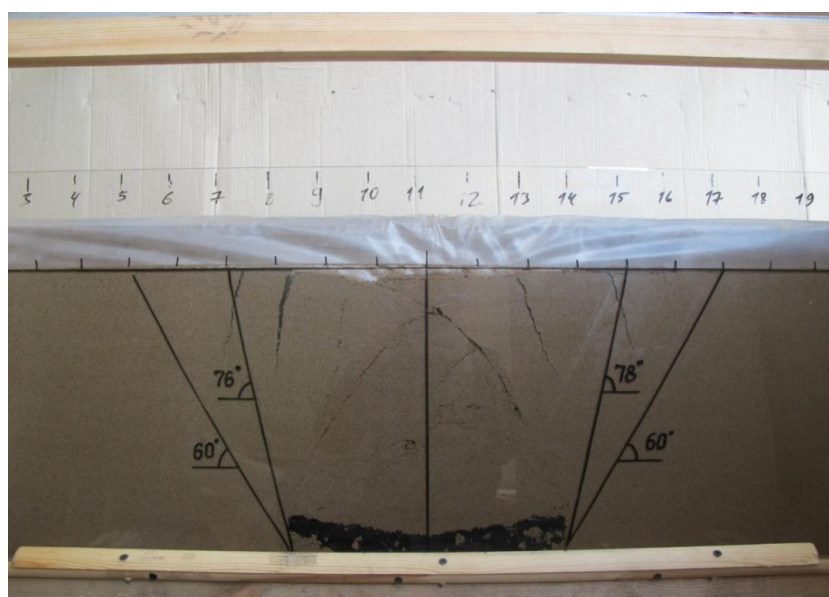
Рисунок. 2. Заключительная фаза моделирования неравномерной подработки (Модель 3-1).
