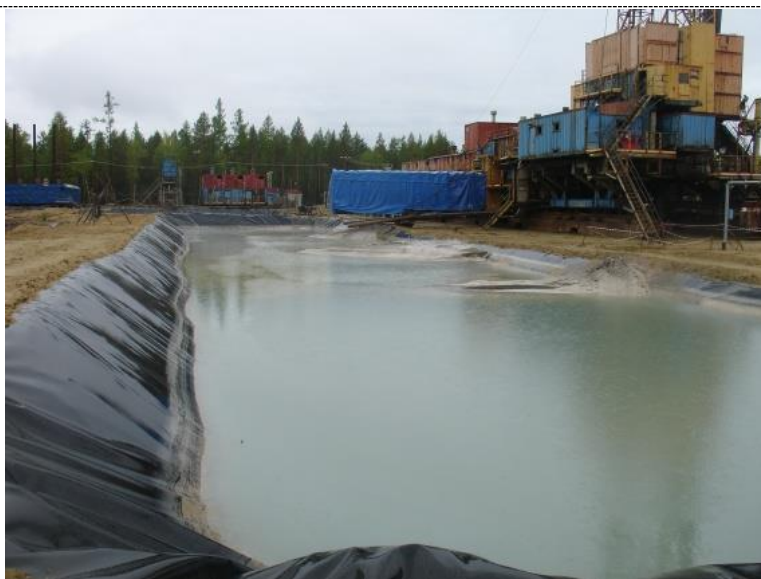
Рисунок 1 – Способ хранения буровых шламов в амбаре
