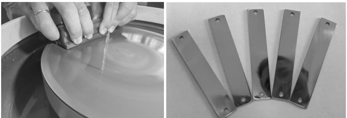
Рисунок 2.13 – Полирование поверхности образцов
