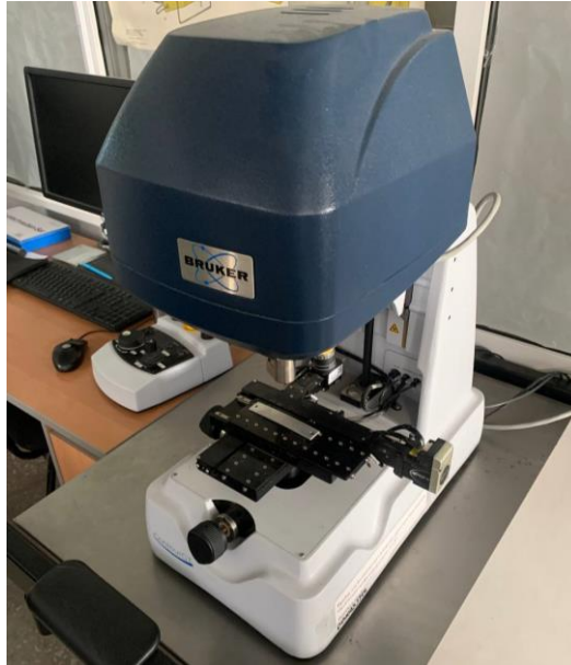
Рисунок 2.16 – Измерение образца на оптическом профилометре Bruker Contour GT-K1
