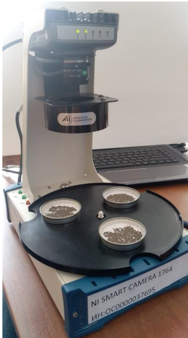
Рисунок 2.21 – Измерение дроби при помощи NI Smart Camera 1764
