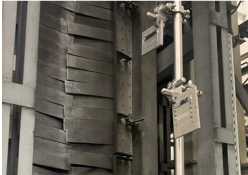
Рисунок 2.14 – Закрепление образца в зажимах установки УДП-2-2.5
