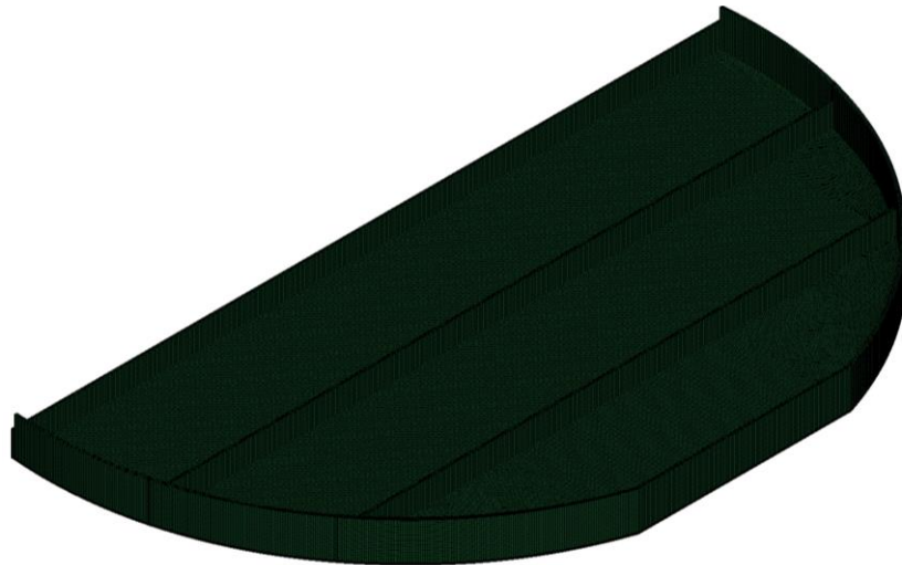
Рисунок 3.20 – Сетка из гексаэдральных элементов модели КПО детали «Стенка»
