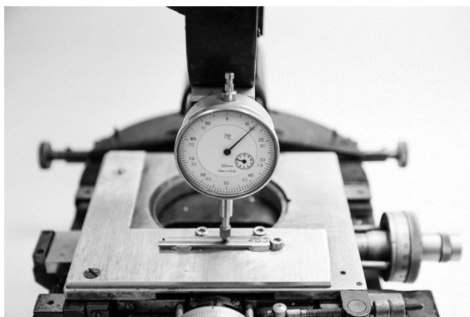
Рисунок 2.11 – Приспособление для измерения стрелы прогиба образцов-полосок
