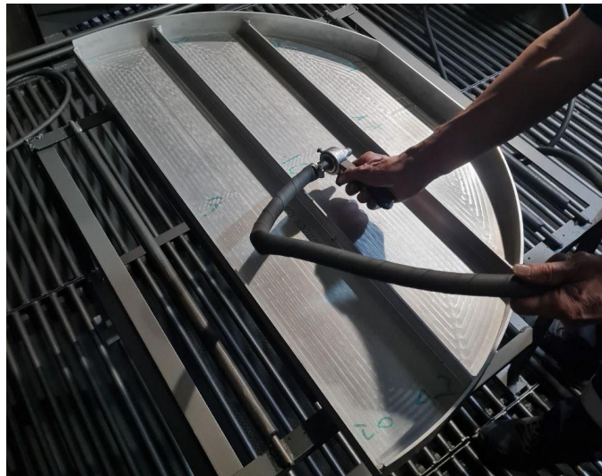
Рисунок 4.7 – Доводка формы КПО дробеструйной обработкой в ДОК
