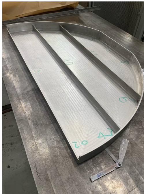
Рисунок 4.3 – Измерение отклонений поверхности полотна КПО от ПЛОСКОСТНОСТИ
