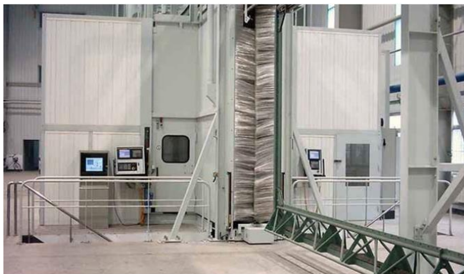
Рисунок 1.7 – Установка для дробеударного упрочнения MPF 20000 [87]
