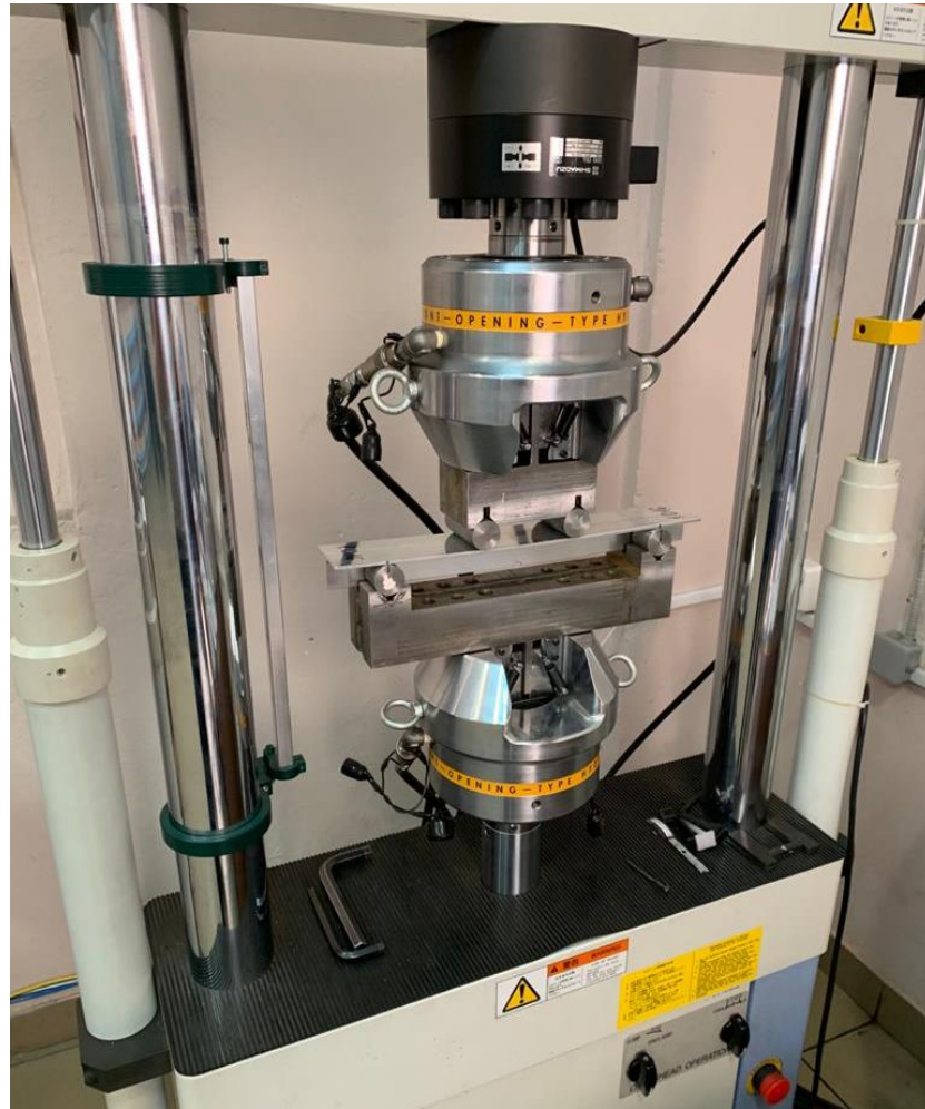
Рисунок 4.10 – Универсальная сервогидравлическая испытательная машина ENF-EV101K2-04N-1E
