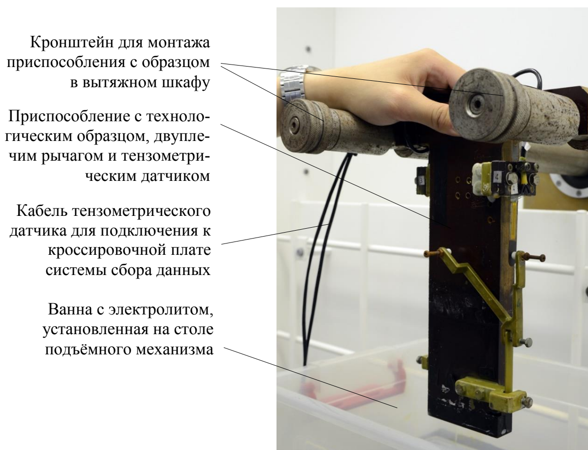
Рисунок 2.12 – Установка приспособления для закрепления образцов в вытяжном шкафу
