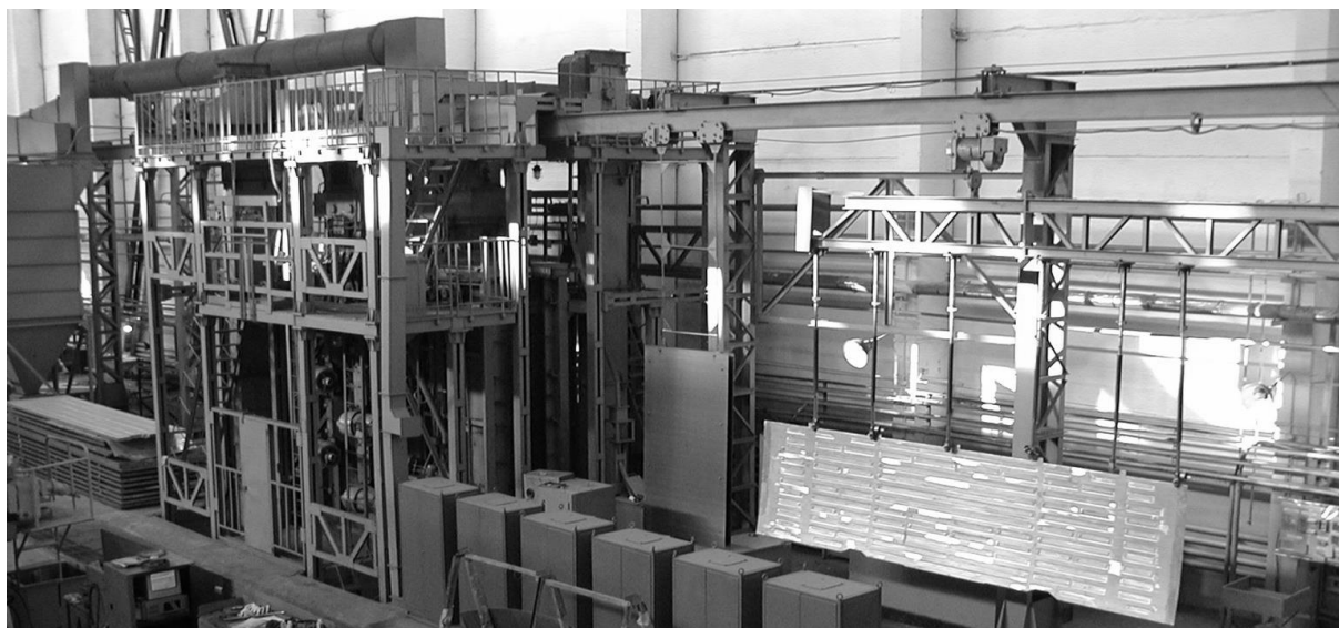
Рисунок 1.8 – Установка дробеметная программная УДП-2-2,5
