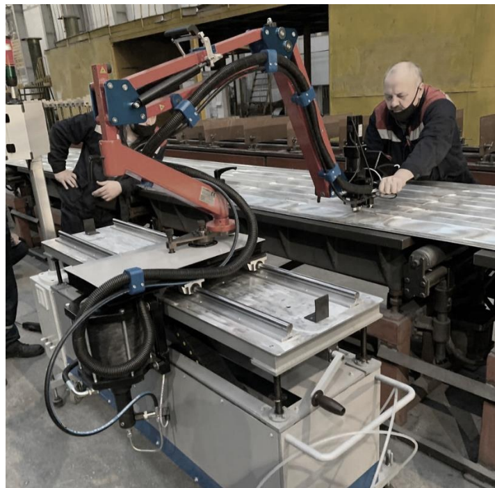
Рисунок 4.21 – Установка для формообразования и правки подкреплённых деталей раскаткой роликами УФП-1
