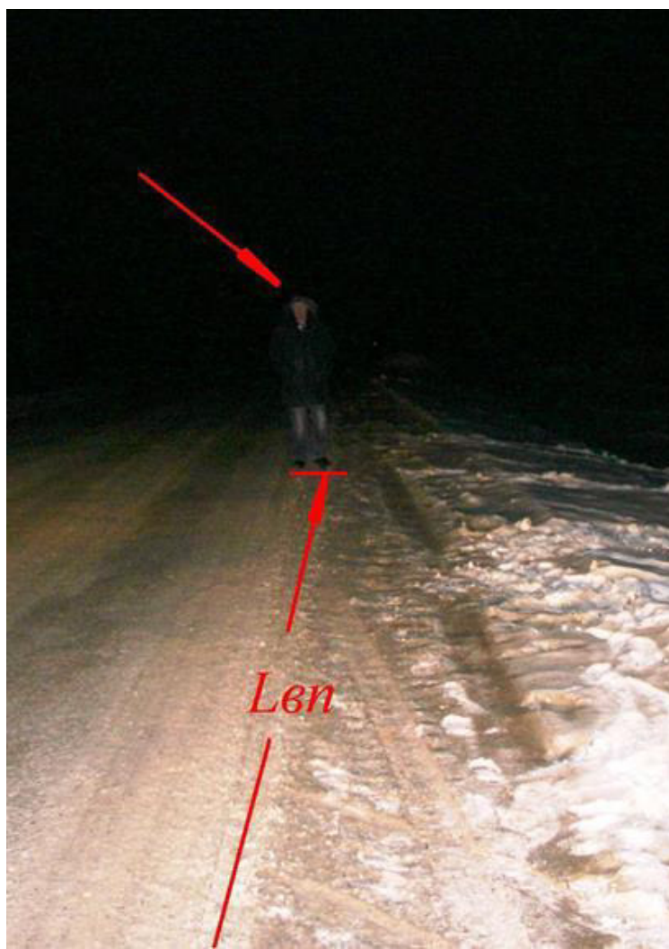
Рис. 1.10. Видимость водителем пешеходов в темной одежде в ТВС на неосвещенной дороге
