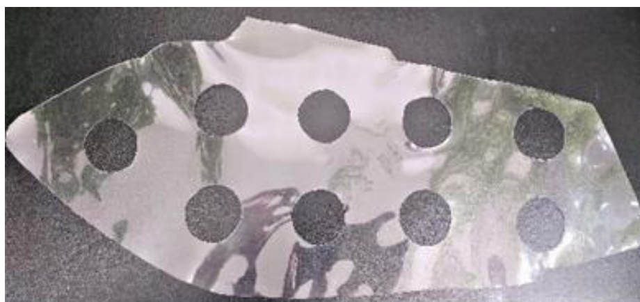
Рис. 3.2. Накладной шаблон для оперативного позиционирования мест контроля светопропускания на поверхности экрана
