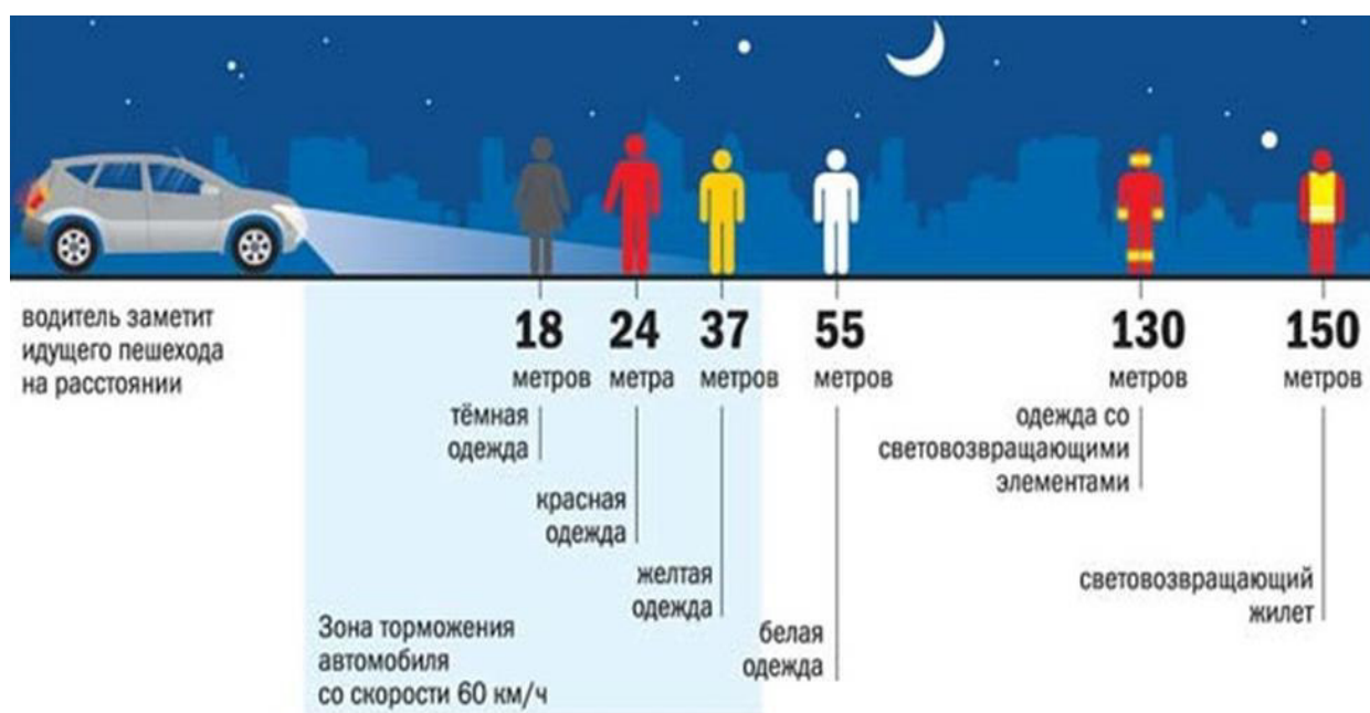
Рис. 1.11. График зависимости расстояния видимости водителем пешеходов в зависимости от цвета их одежды [103]
