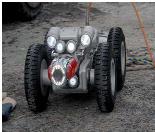
Рис. 4. Самоходная роботизированная платформа для теледиагностики осушенных трубопроводов
