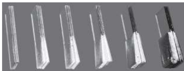
Рис. 2. Многослойное пожаростойкое стекло с твердым теплопоглощающим вспенивающимся гелем и его поэтапное взаимодействие под воздействием огня
