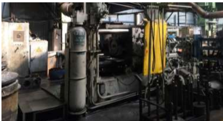
Рис. 1. Машина для литья под давлением CLPO 400-55
