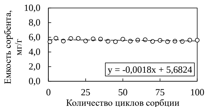
Рисунок 8 – Изменение емкости сорбента в зависимости от количества циклов сорбции и десорбции лития
