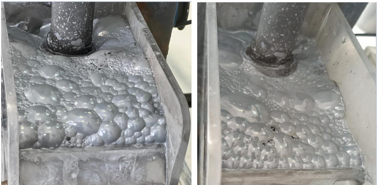
Рисунок 20 – Флотационная пена в эксперименте при плотности пульпы 20 % тв.
