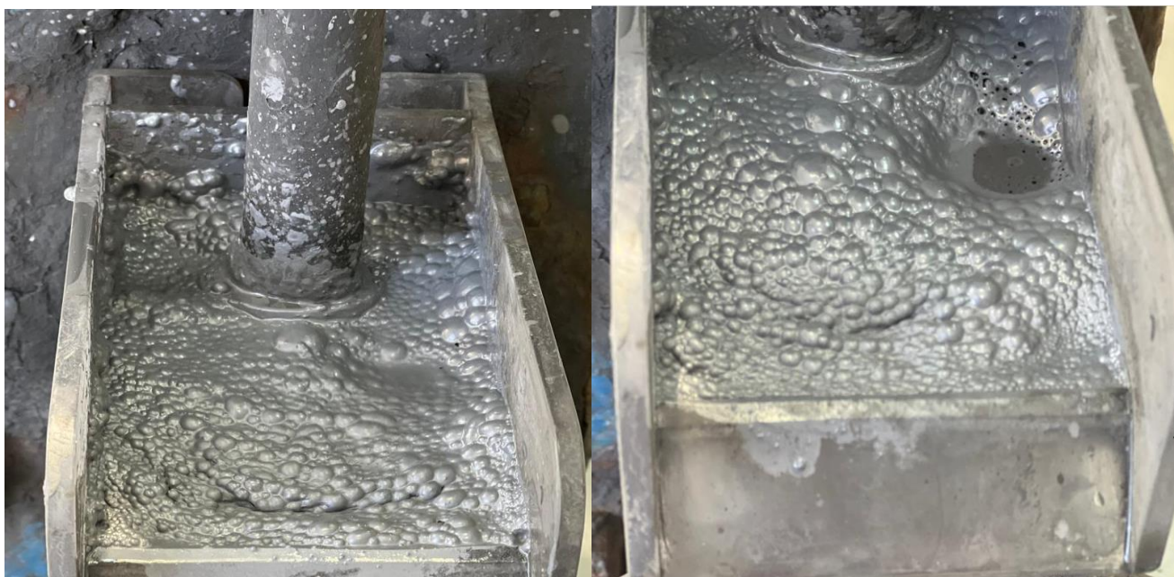
Рисунок 21 – Фото пенного слоя в эксперименте с расходом воздуха – 1 л/мин
