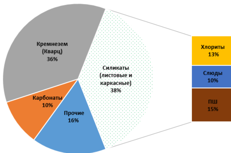
Рисунок 11 – Распределение различных классов породообразующих минералов в общем количестве нерудных компонентов сульфидных руд
