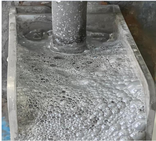
Рисунок 23 – Пенный слой в эксперименте при повышении скорости вращения импеллера до 45 \text{ с}^{-1}
