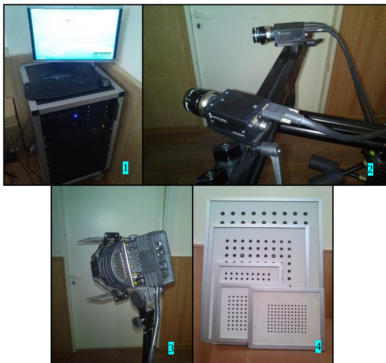
Рис. 1. Система бесконтактного анализа перемещений и деформаций Vic-3D: 1 – вычислительная станция, 2 – приемник светового сигнала (цифровые камеры), 3 – излучатель света, 4 – набор калибровочных таблиц
