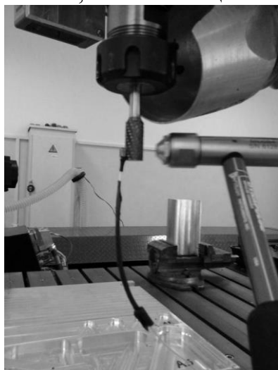
Рис. 1 Размещение акселерометра на фрезе
