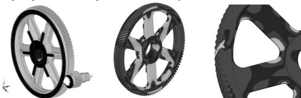
Рис. 6. Расчетная схема контактной пары и НДС зубчатого колеса под действием эксплуатационного нагружения и контактного давления от шестерни
