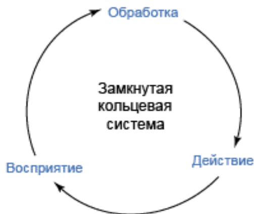
Рис. 3. Замкнутая кольцевая система взаимодействия робота с окружающей средой
