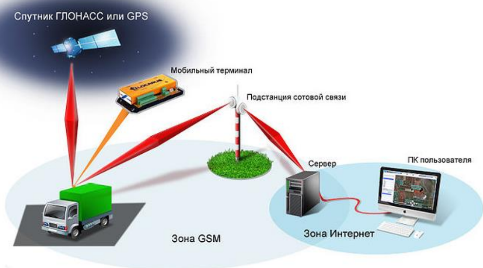
Рис. 1. Принцип работы спутникового мониторинга транспорта
