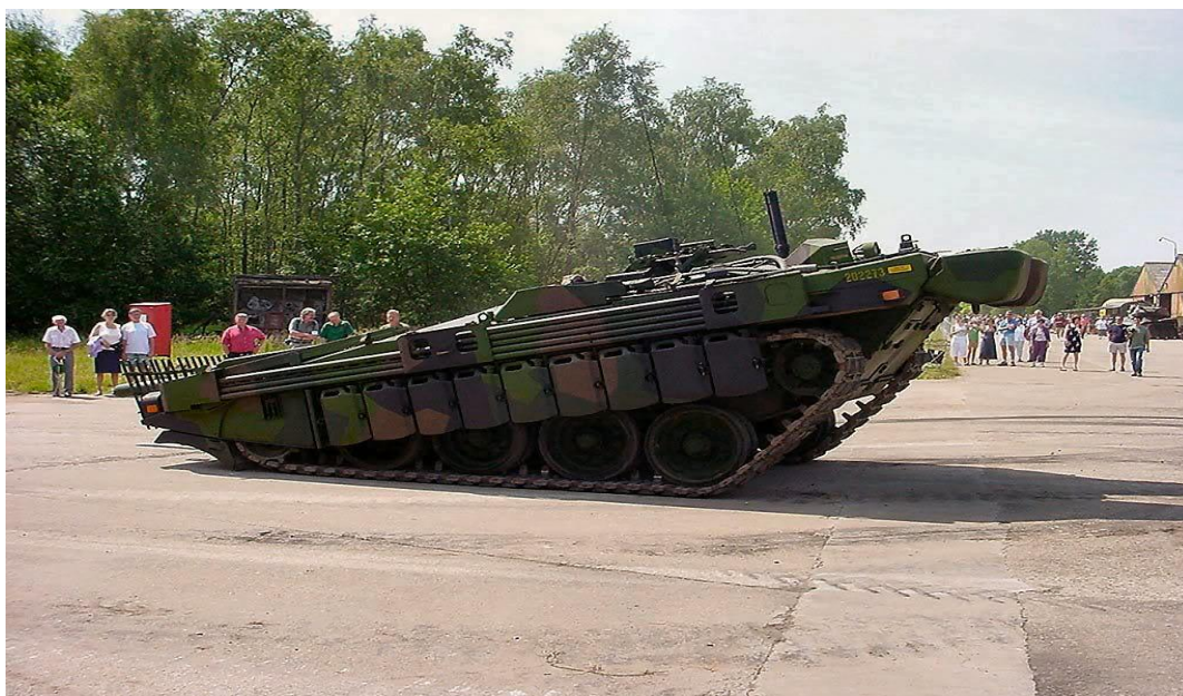
Рис. 1. Управление положением корпуса боевой машины при работе системы управления положением корпуса
