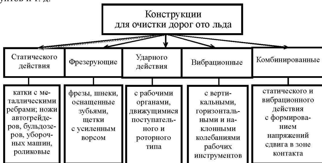
Рис. 2. Классификация рабочих органов для разрушения снежно-ледяных образований
