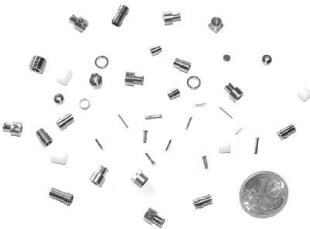
Рис. 4. Детали, изготавливаемые на автомате продольного точения с ЧПУ Citizen диаметром точения до 16 мм
