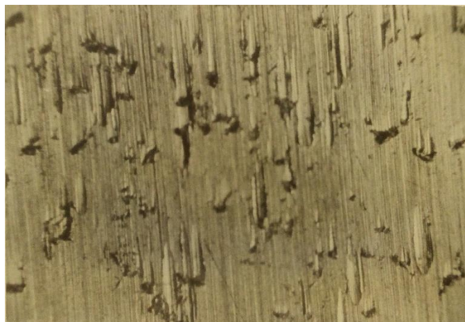
Рис.2 Мгновенная контактная поверхность увеличено в 450 раз
