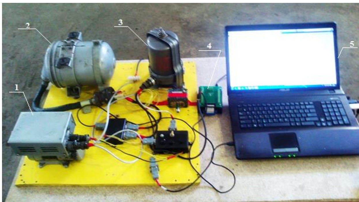
Рис. 4. Внешний вид компьютерного измерительного комплекса: 1 – преобразователь напряжения ПТ-125Ц; 2 – Центральная гировертикаль ЦГВ-4К; 3 – Гирокомпас Г-3М; 4 – Аналого-цифровой преобразователь ZET 210; Компьютер Notebook
