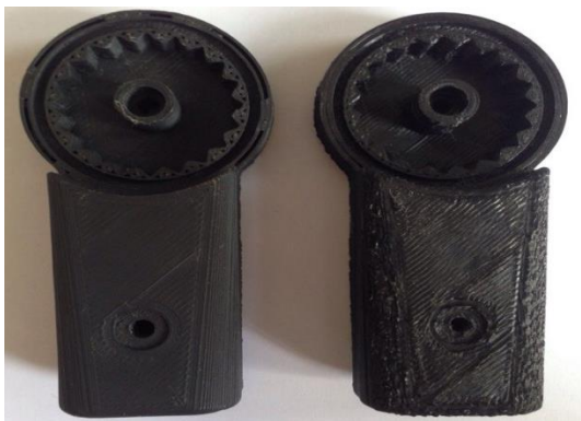
Рис. 8. Слева направо: бездефектная деталь, деталь с дефектом типа «волнистость»
