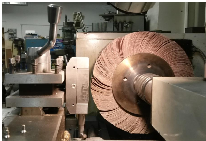
Рис. 1. Процесс установки лепесткового круга и образца для исследования
