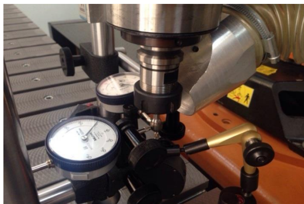
Рис.2. Схема установки микрометров по трём осям координат X, Y, Z
