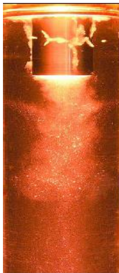
Рис. 3. Возникновение кавитации вокруг волновода
