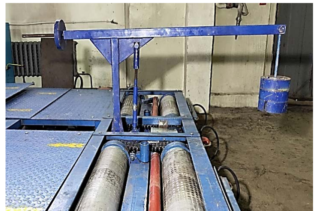
Б – механическое калибровочное устройство, установленное на стенде
