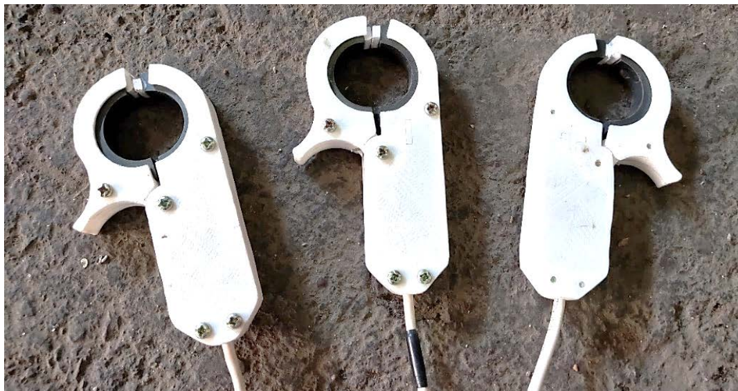
Рисунок 3.11 – Разработанные токоизмерительные датчики системы измерения параметров функционирования ЭСП
