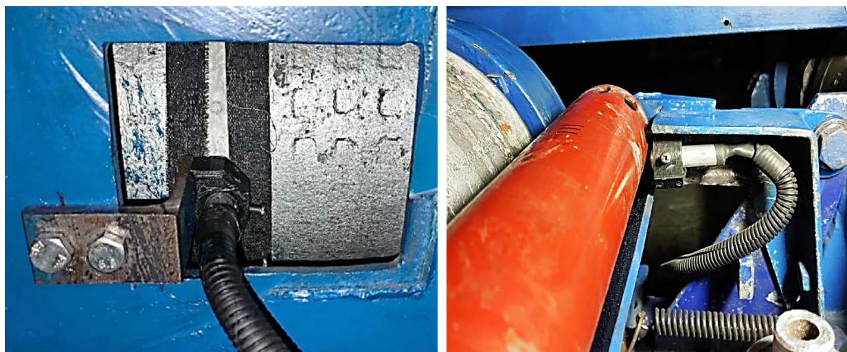
А – индуктивный преобразователь, измеряющий вращение ББ
