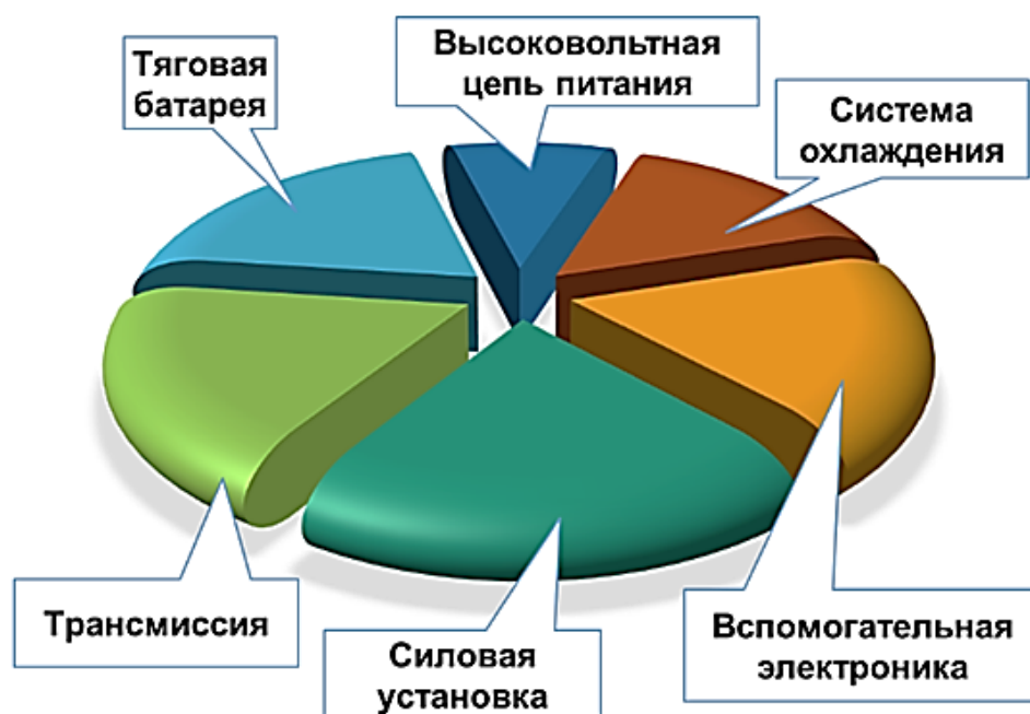
Рисунок 1.2 – Основные системы и агрегаты АЭСП, в которых возникают неисправности
