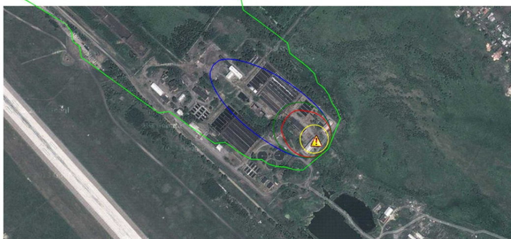
Рис. 7. Зоны распространения хлорного облака при сценарии полного разрушения контейнера с жидким хлором
