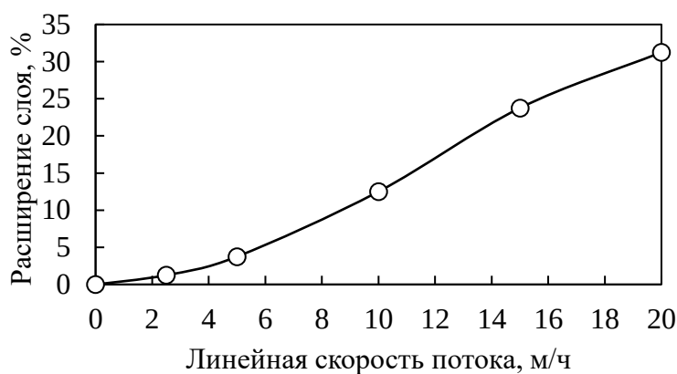
Рисунок 23 - Расширение слоя Al-Li-СДГ сорбента в зависимости от линейной скорости потока
