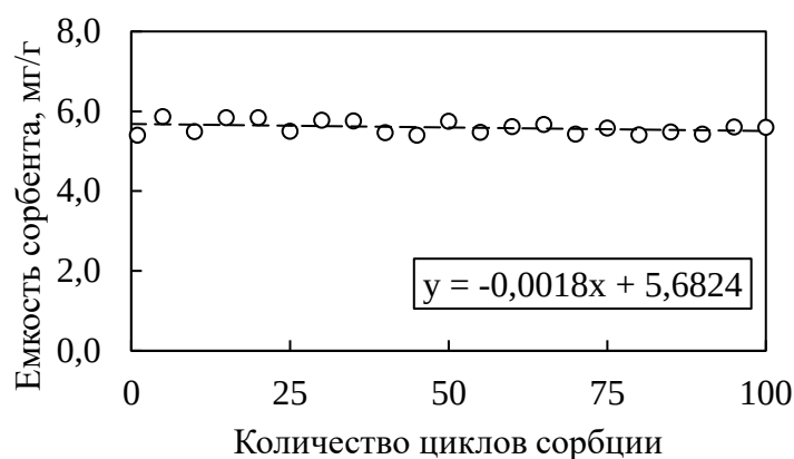
Рисунок 34 - Изменение емкости сорбента в зависимости от количества циклов сорбции и десорбции лития
