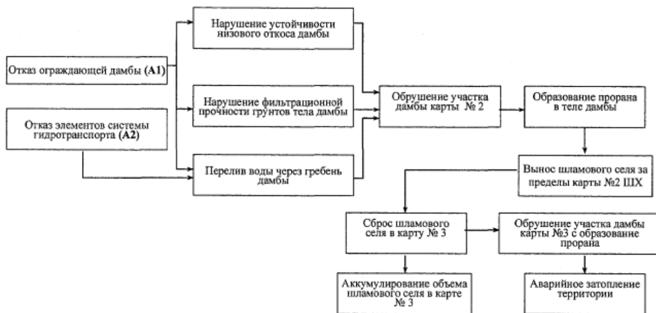
Рис. П.2.5. Блок-схема развития аварийного процесса для сценариев А1 и А2 на карте № 2 шламохранилища
