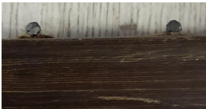
Рис. 5. Выгиб шпилек и риска от удара образца с оснасткой
