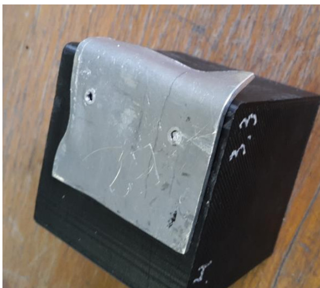
Рис. 8. Форм-блок из PLA-пластика и образец после МИШ
