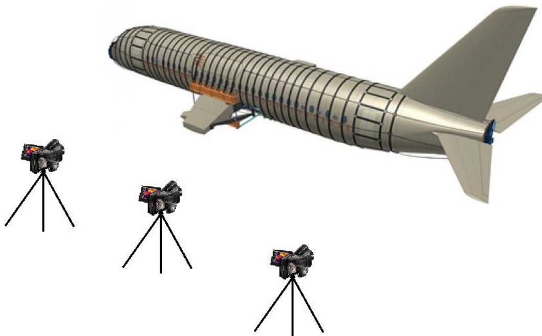
Рис.3. Контроль герметичности фюзеляжа самолета предлагаемым методом
