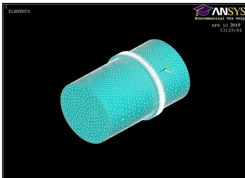
Рис. 2. Конечно-элементная модель редуктора
