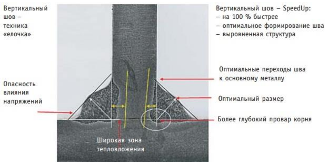
Рис.8 – Сравнение провара шва техникой «ёлочка» (слева) и SpeedUp (справа) [7]
