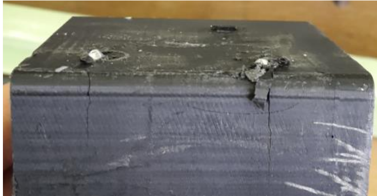
Рис. 9. Разрушение форм-блока после МИШ
