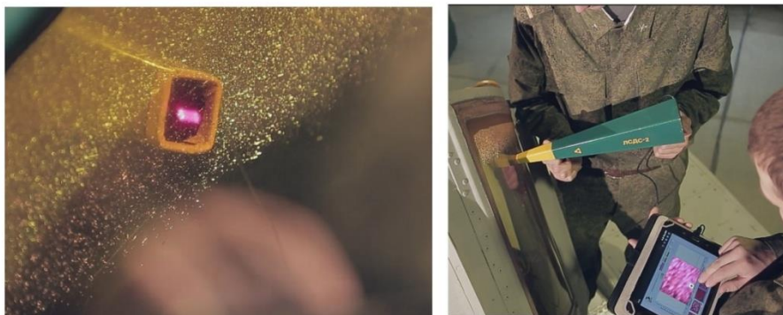
Рис.3. Дефектоскопический контроль остекления фонаря кабины
