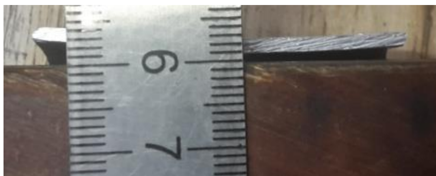
Рис. 4. Неприлегание образца на балинитовой оснастке
