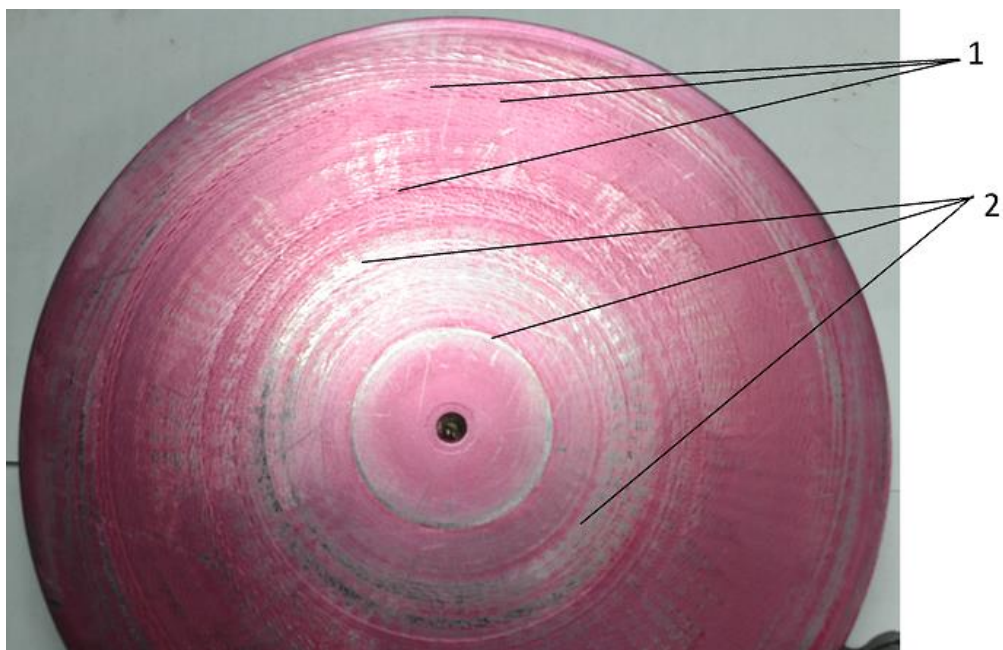
Рис. 2. Образец типа диск после обработки АВ, полученный при V = \text{const} с участками контактных зон
