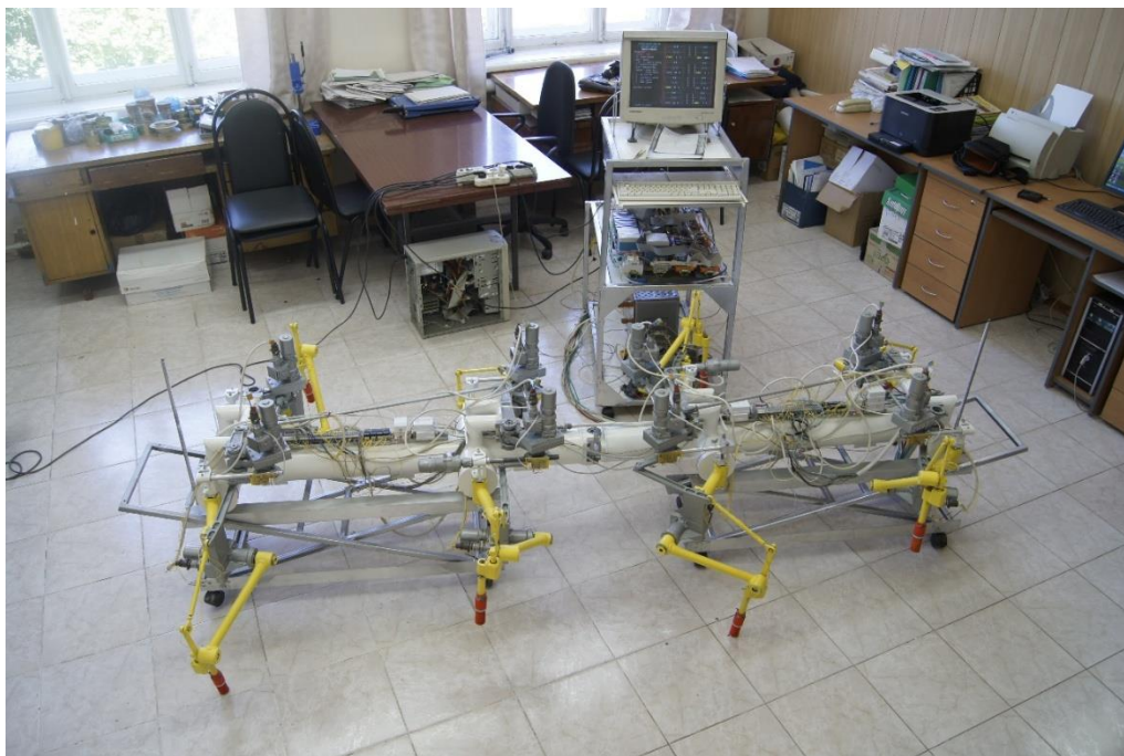
Рис. 1 Лабораторный образец восьминой шагающей машины
