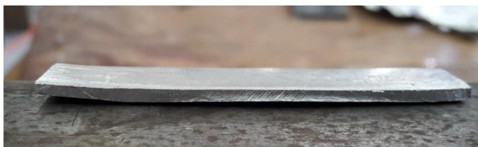
Рис. 6. Неприлегание образца на стальной оснастке
