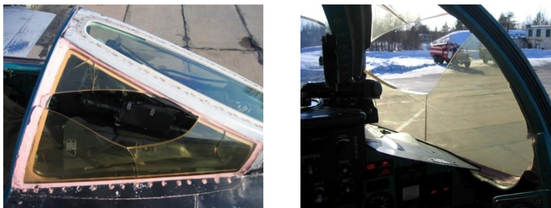
Рис. 2. Разрушение остекления фонаря кабины самолета
