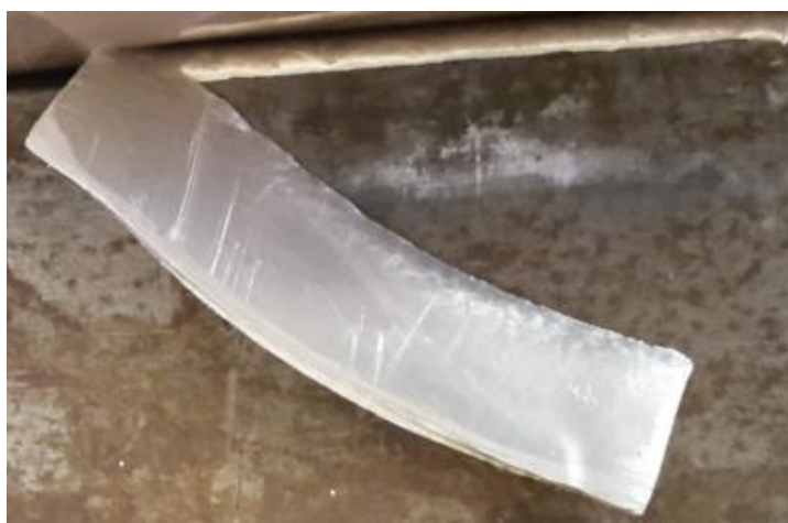
Рис. 7. Отрыв края образца
