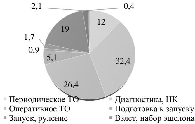
Рис. 1. Выявление отказов по этапам эксплуатации магистральных ВС (ТО – техническое обслуживание; НК – неразрушающий контроль)
