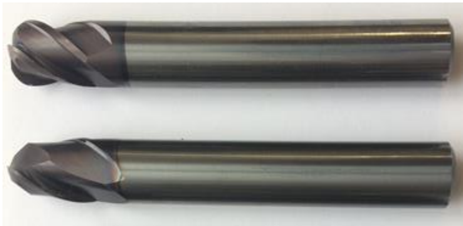
Рис. 1. Сфероцилиндрические фрезы с двумя и четырьмя зубьями, используемые в исследовании
