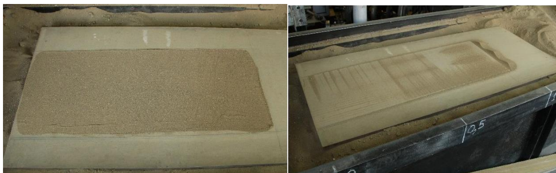
Рис. 2 а) Очищаемая поверхность с распределенными загрязнениями, б) Очищаемая поверхность с остаточными загрязнениями
