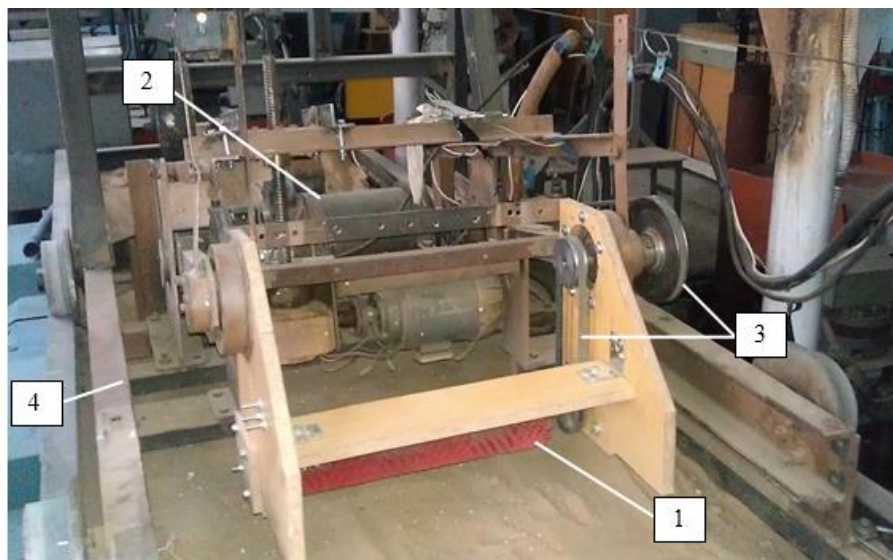
Рис. 1 Экспериментальная установка: 1 – цилиндрическая щетка; 2 – электродвигатель постоянного тока; 3 – ременная передача; 4 – самоходная тележка
