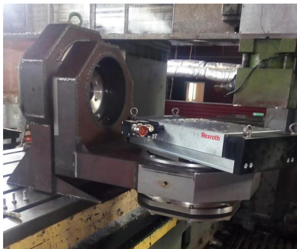
Рис. 5. Трех-осевая шпиндельная головка (без мотор-шпинделя)
