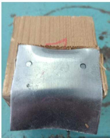
Рис. 3. Форм-блок из сухой сосны и образец после МИШ
