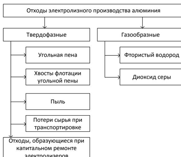
Рисунок 1 – Классификация отходов при электролизе алюминия
