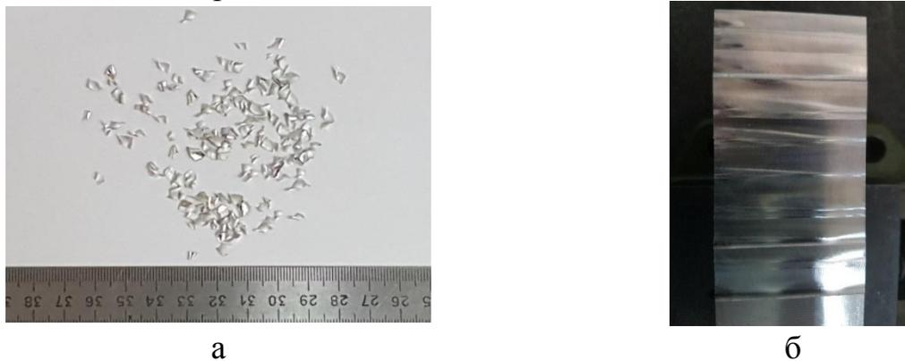
Рисунок 11 – Результаты проведения экспериментов: а – получаемая стружка; б – обработанная поверхность
